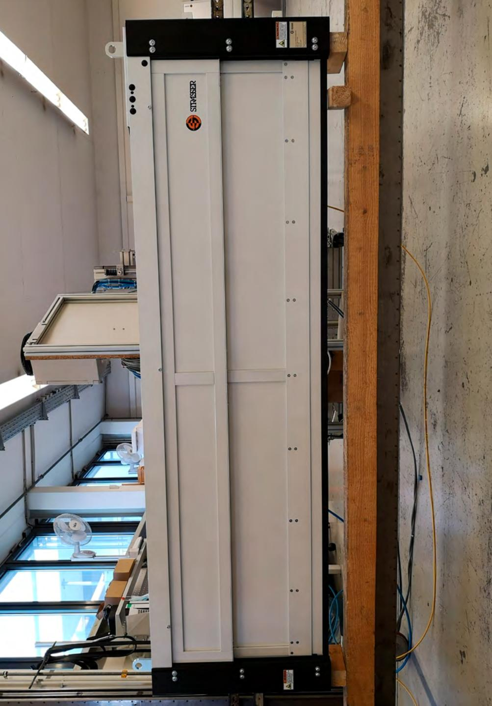
MecLock Vertikal-Schutzfenster SFV.D-B01-E-4000-FO – servoelektrisch angetrieben
