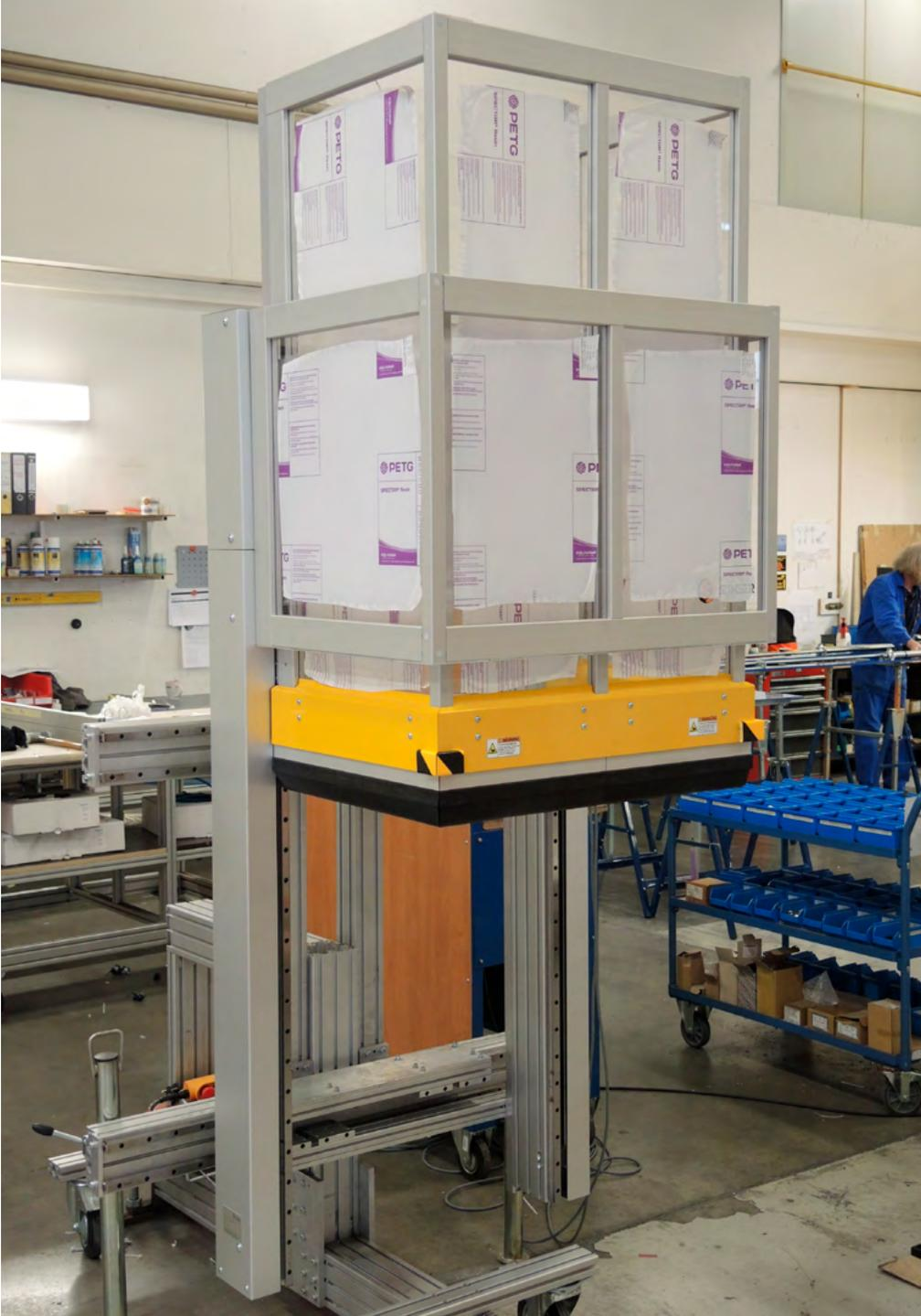
MecLock Vertikal-Schutzfenster SFV.F-B30-P-2350-FO – pneumatisch angetrieben
