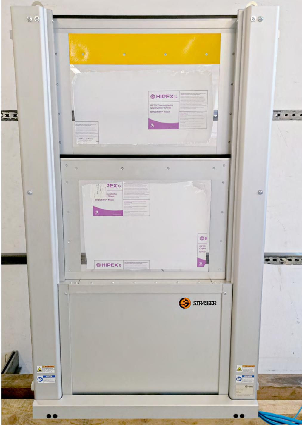
MecLock Vertikal-Schutzfenster SFV.D-B01-P-1500-FO – pneumatisch angetrieben mit teleskopierendem Scheibenrahmen – Schließrichtung von unten nach oben mit hinterfahrbarer Kontakteleiste – barrierefrei oben – geschlossene Endlage
