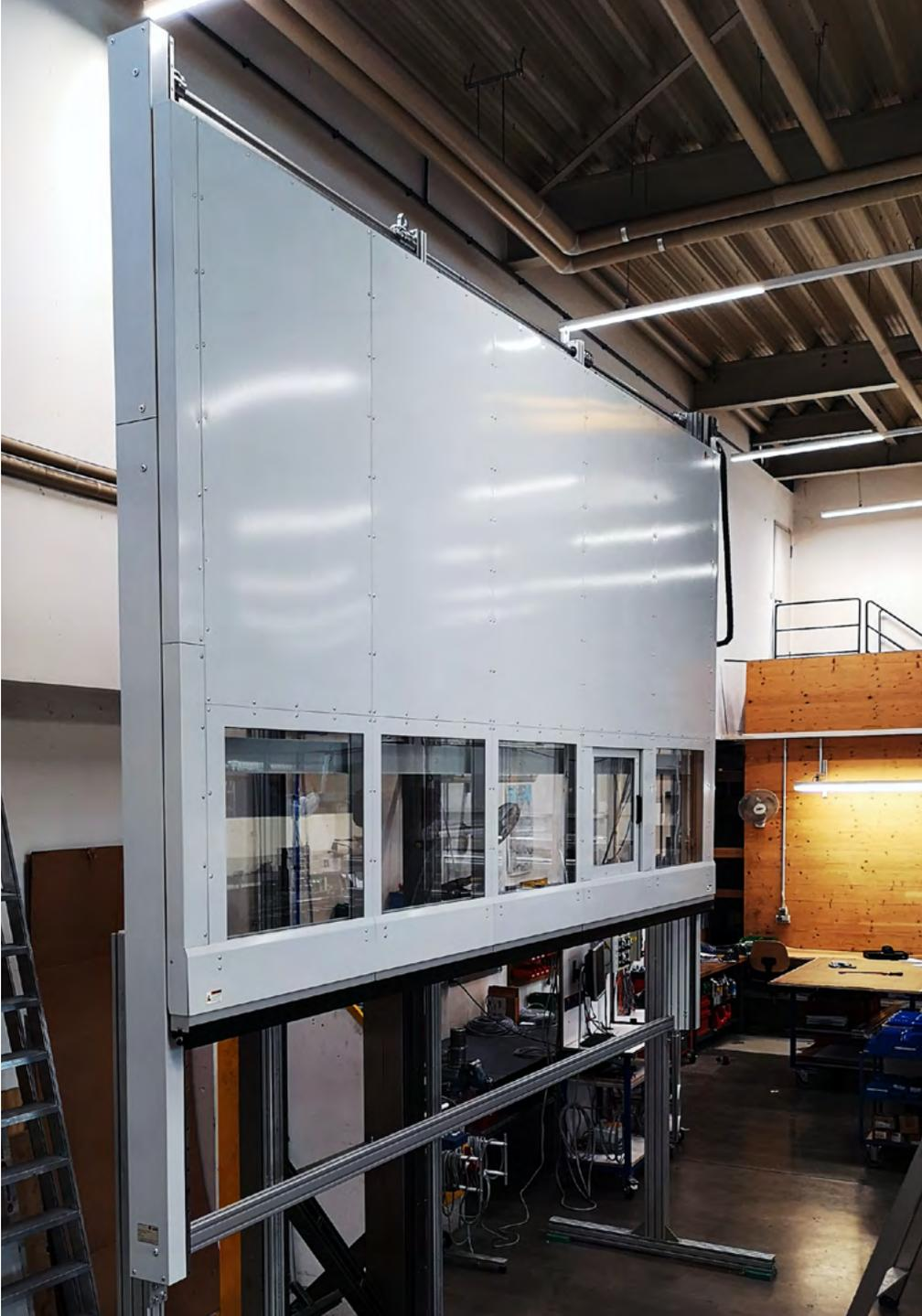
MecLock-Schutteinrichtung für einen Trockner für Fadenstränge – Schutz vor mechanischen Gefahren und zur Abdichtung gegen explosive Stoffe – maximale Temperatur an der Maschineninnenseite 75 °C – geöffnete Position
