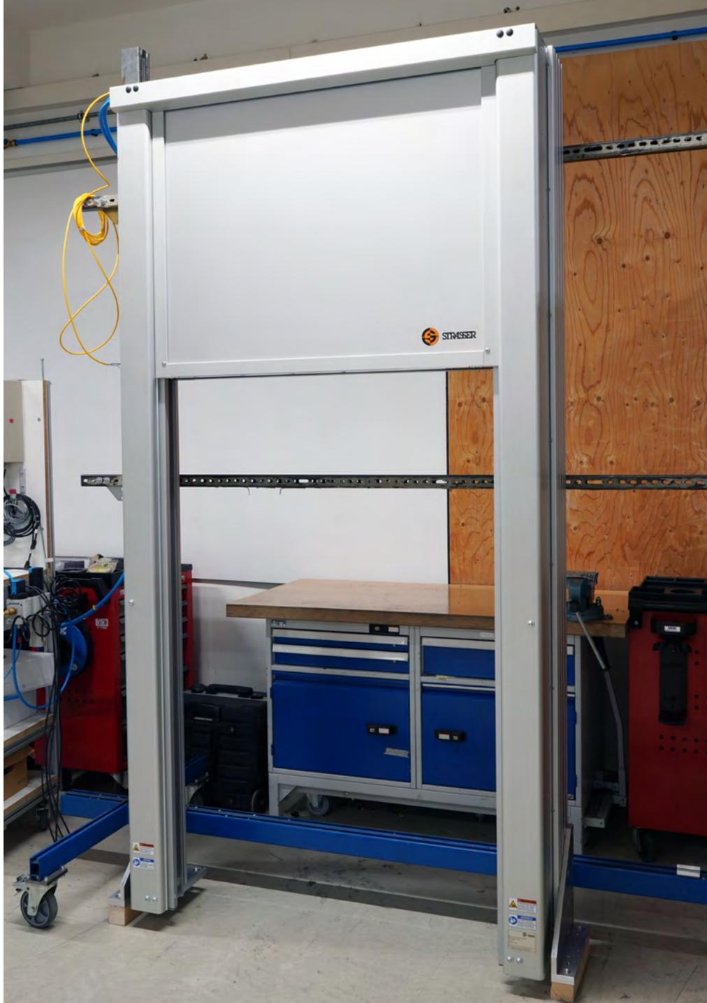
MecLock Vertikal-Schutzfenster SFV.D-B01-P-1500 – pneumatisch angetrieben mit teleskopierendem Scheibenrahmen – Schließrichtung von oben nach unten ohne Querprofil unten – mit hinterfahrbare Kontaktleiste - geöffnete Endlage
