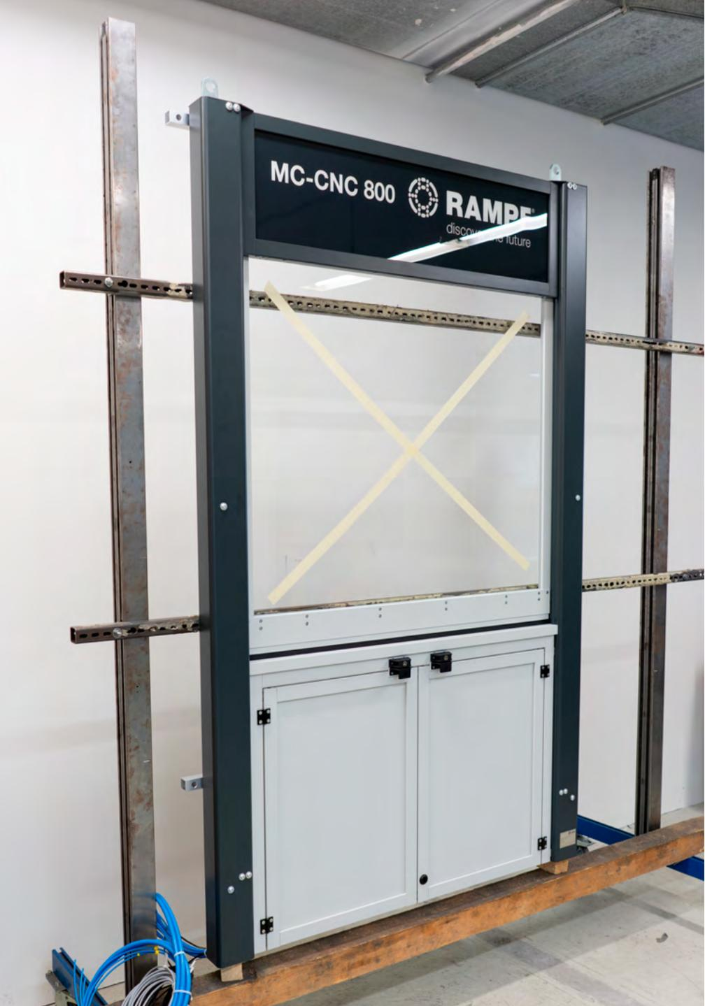
MecLock Vertikal-Schutzfenster SFV.D-B01-P-1500-SA – pneumatisch angetrieben mit verkürzter Blende oben – geschlossene Endlage – für Multifunktionszelle RAMPF (modulares Zellenkonzept zum Dosieren, Fügen, Montieren und Prüfen)
