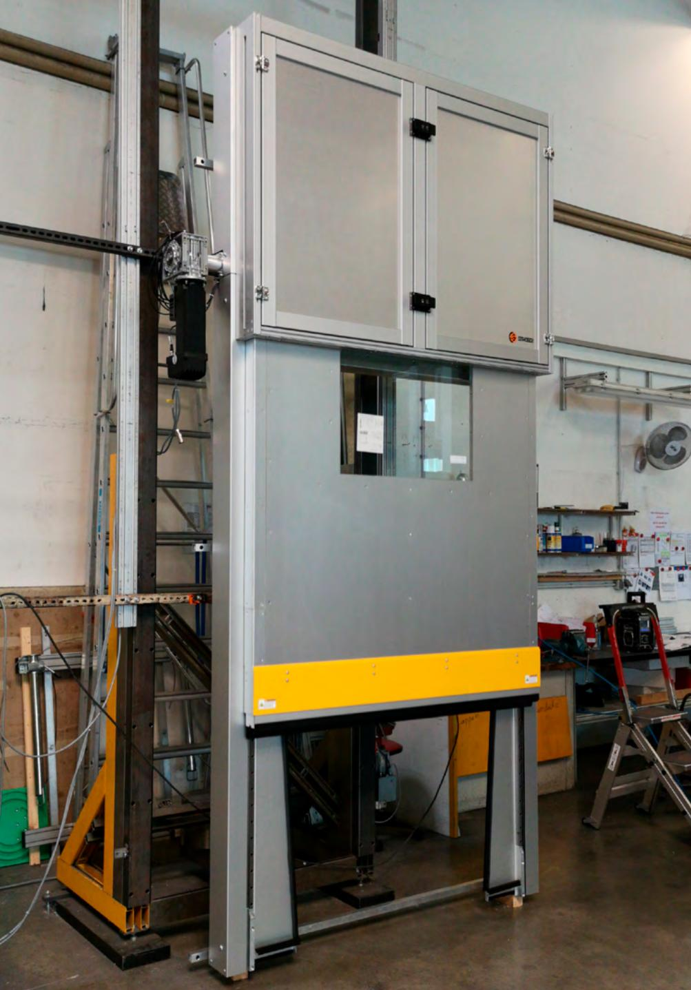
MecLock Vertikal-Schutzfenster SFV.F-B99-E-7200-FO – servoelektrisch angetrieben
