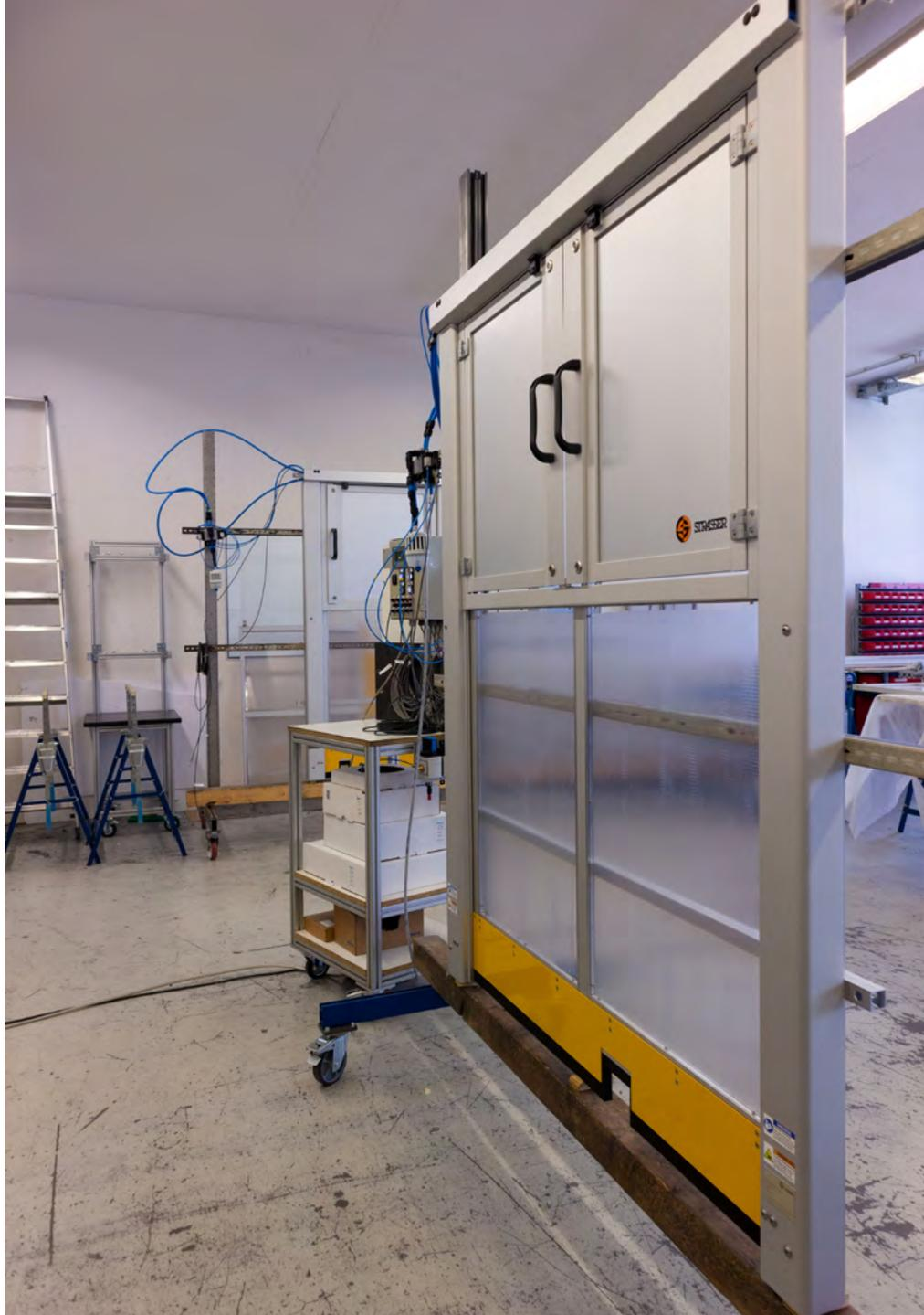
MecLock Vertikal-Schutzfenster SFV.D-B01-P-1500-FO – pneumatisch angetrieben
