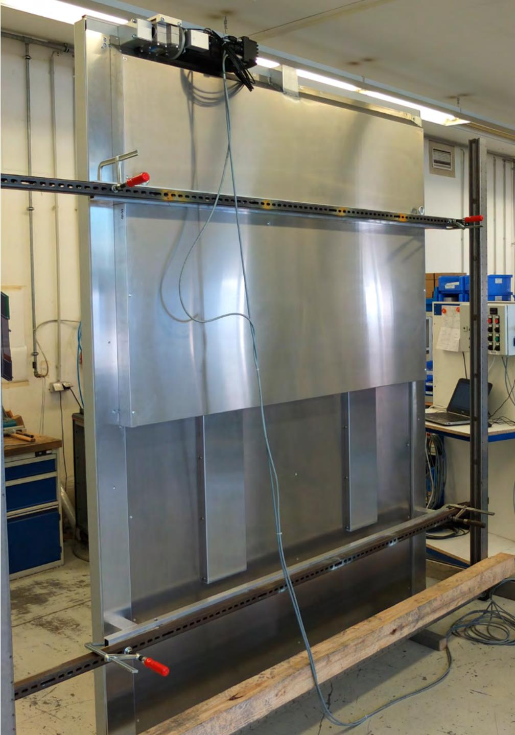
MecLock Vertikal-Schutzfenster SFV.D-B01-E-4000-FM – servoelektrisch angetrieben
