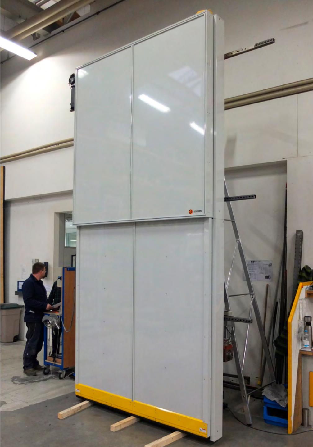
MecLock Vertikal-Schutzfenster SFV.F-B01-E-7200 – servoelektrisch angetrieben
