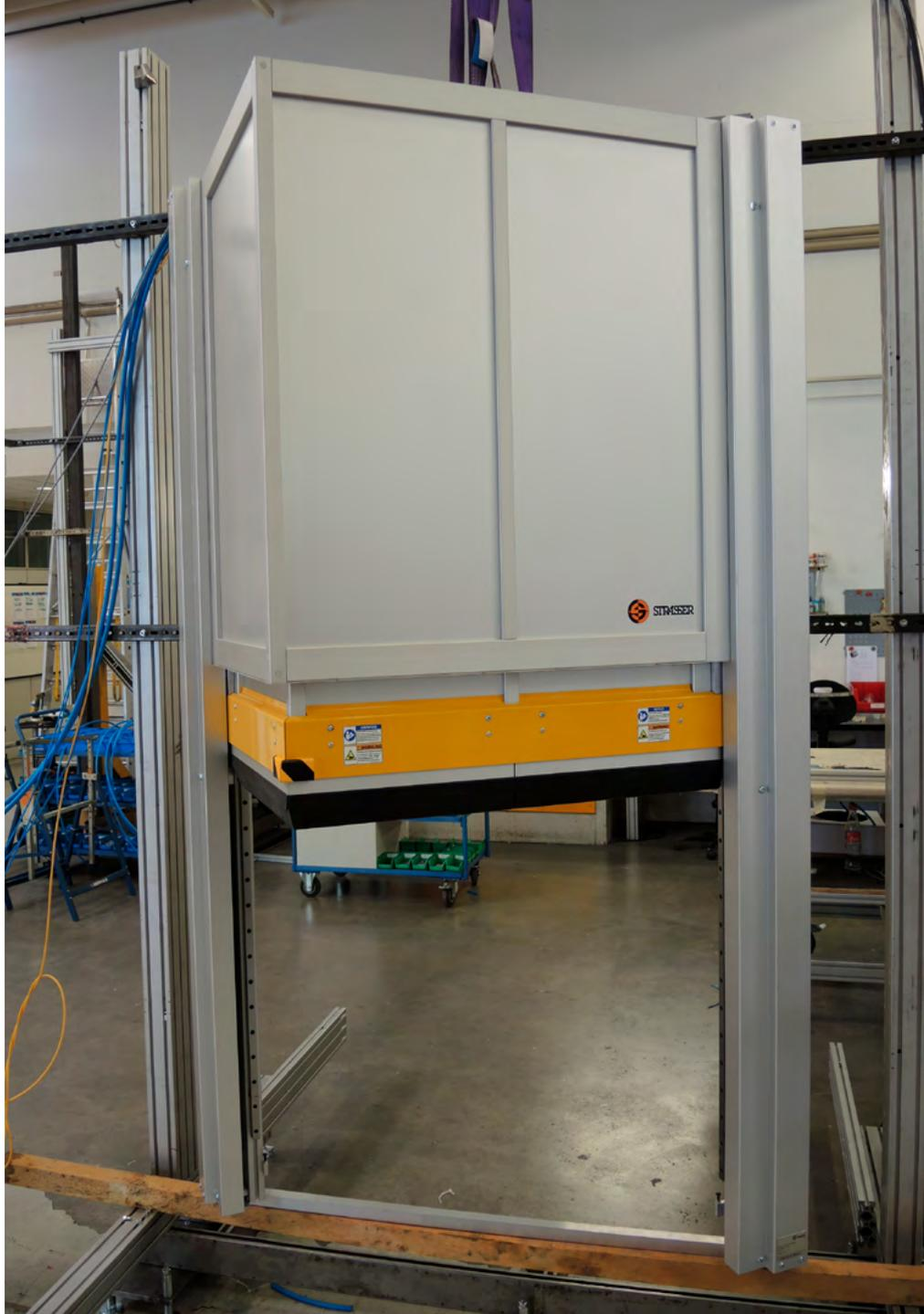
MecLock Vertikal-Schutzfenster SFV.F-B10-P-2350-FO – pneumatisch angetrieben
