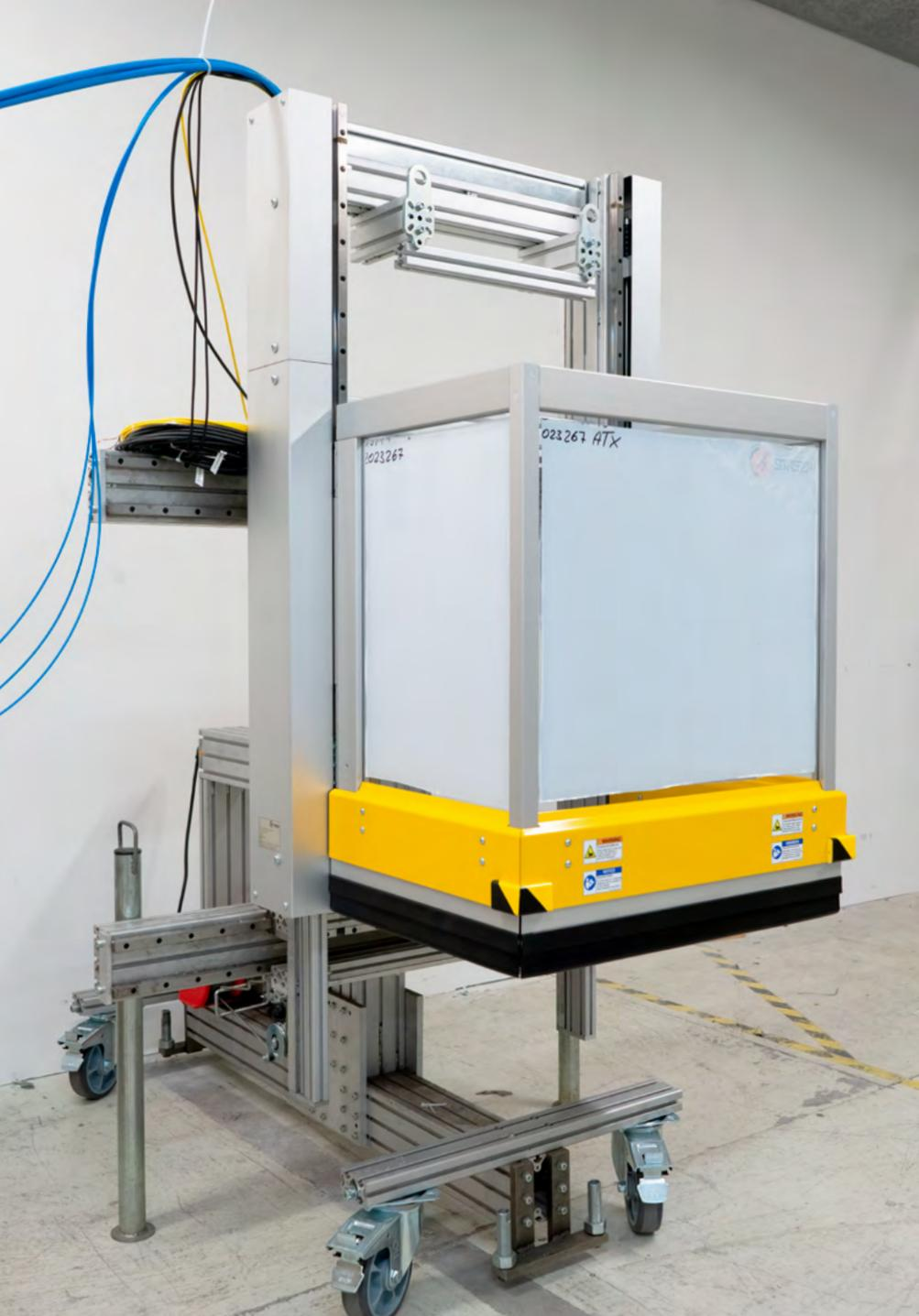
MecLock Vertikal-Schutzfenster SFV.F-B30-P-2350-FO – pneumatisch angetrieben
