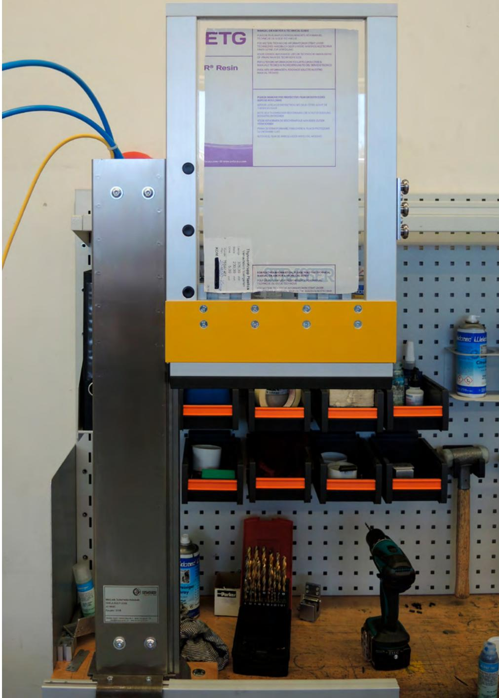
MecLock Sicherheits-Hubsäule SHS.A – pneumatisch angetrieben
