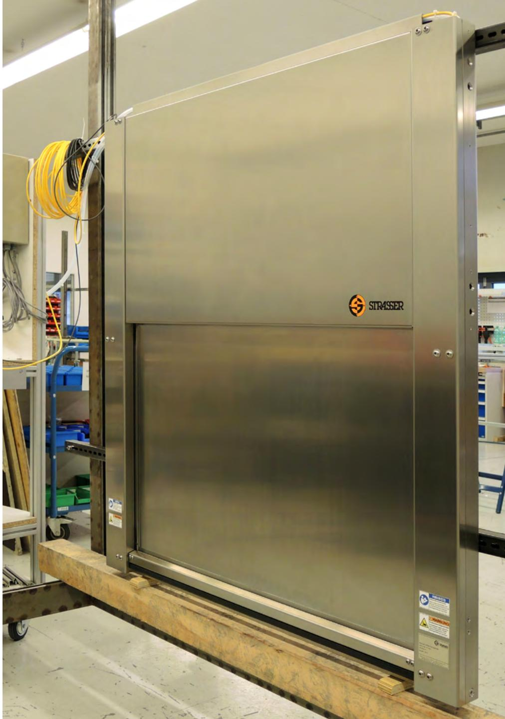
MecLock Vertikal-Schutzfenster SFV.C-B01-P-1500-FM – pneumatisch angetrieben
