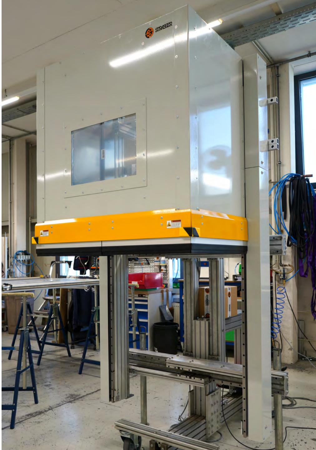
MecLock Vertikal-Schutzfenster SFV.F-B30-E-7200-FO – servoelektrisch angetrieben für End-of-Line-Dichtheitsprüfstand Hydraulikpumpen mit bis zu 4000 bar – geöffnete Endlage
