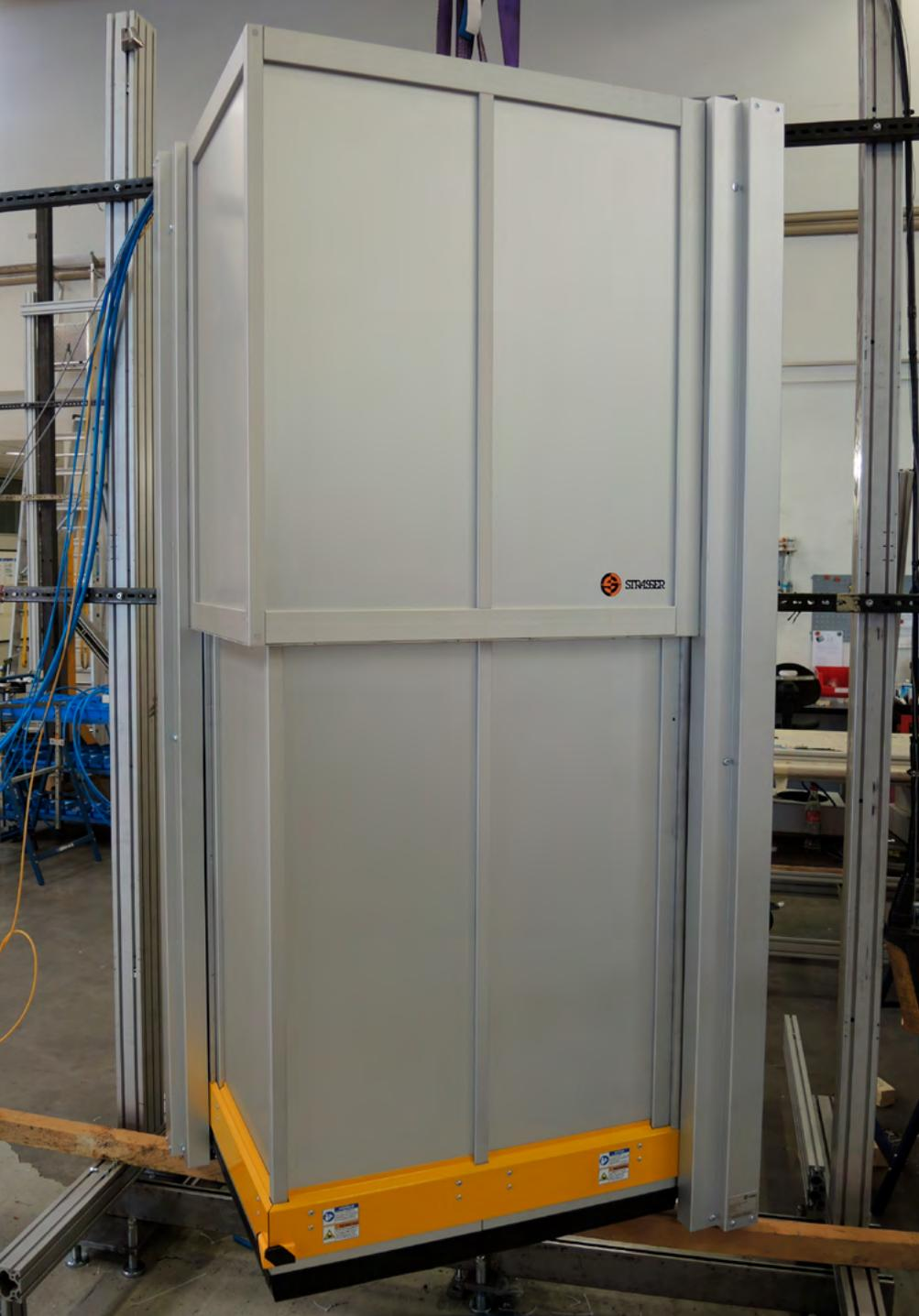
MecLock Vertikal-Schutzfenster SFV.F-B10-P-2350-FO – pneumatisch angetrieben
