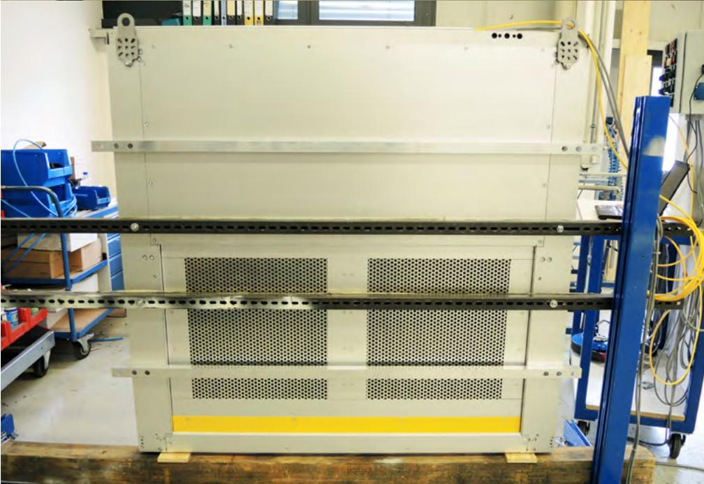
MecLock Vertikal-Schutzfenster SFV.D-B01-E-4000-FM – servoelektrisch angetrieben
