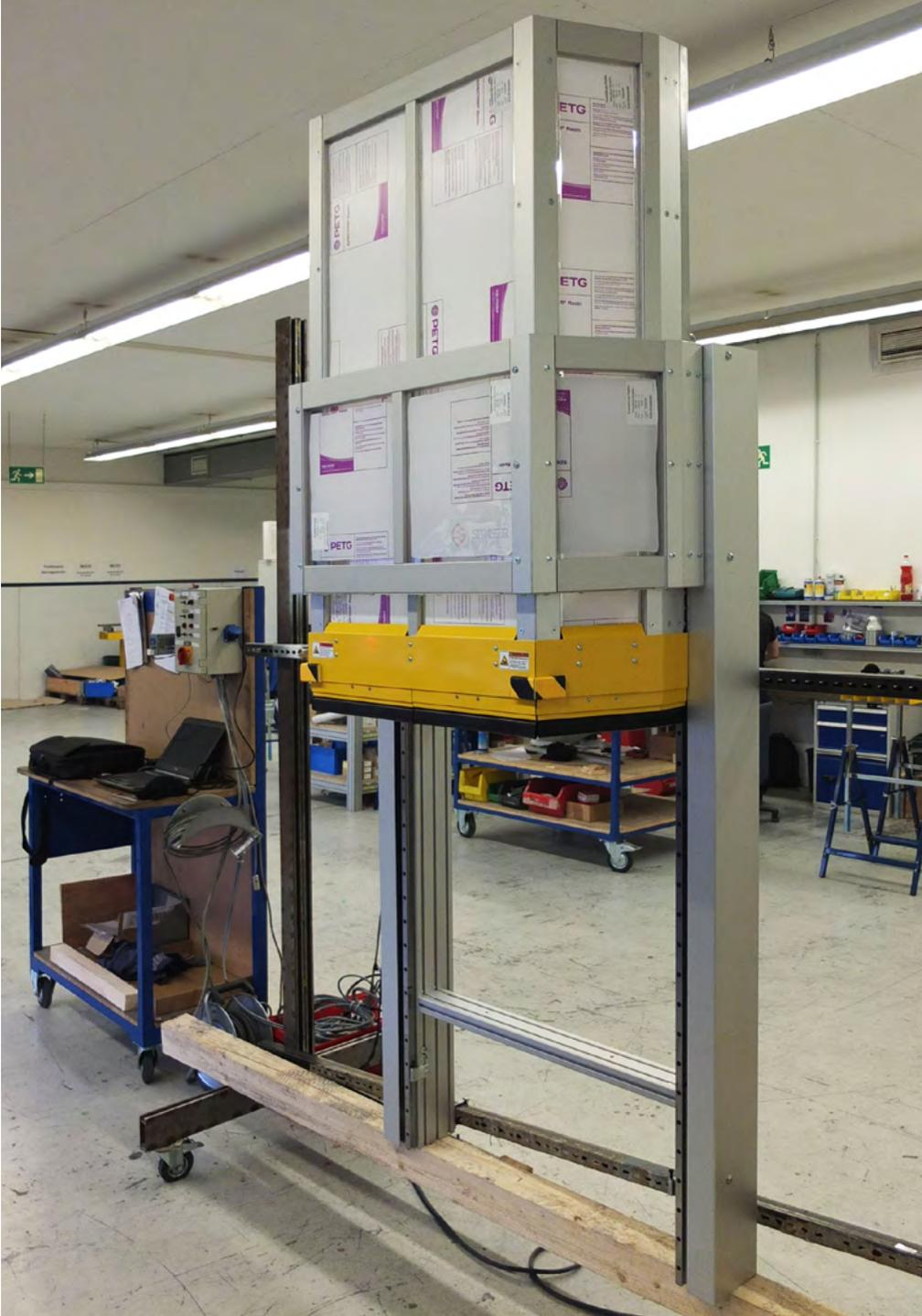
MecLock Vertikal-Schutzfenster SFV.F-B99-E-7200-FO – servoelektrisch angetrieben
