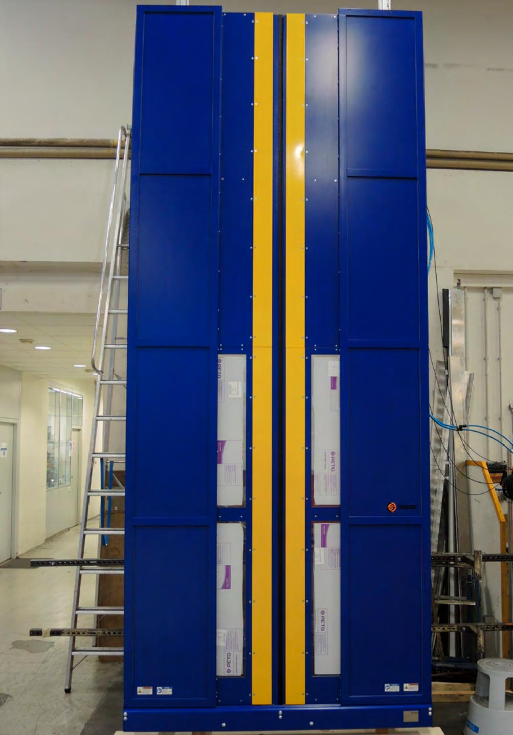
MecLock Horizontal-Schutzfenster SFH.E-B99-P-1500-FK-SA – pneumatisch angetrieben
