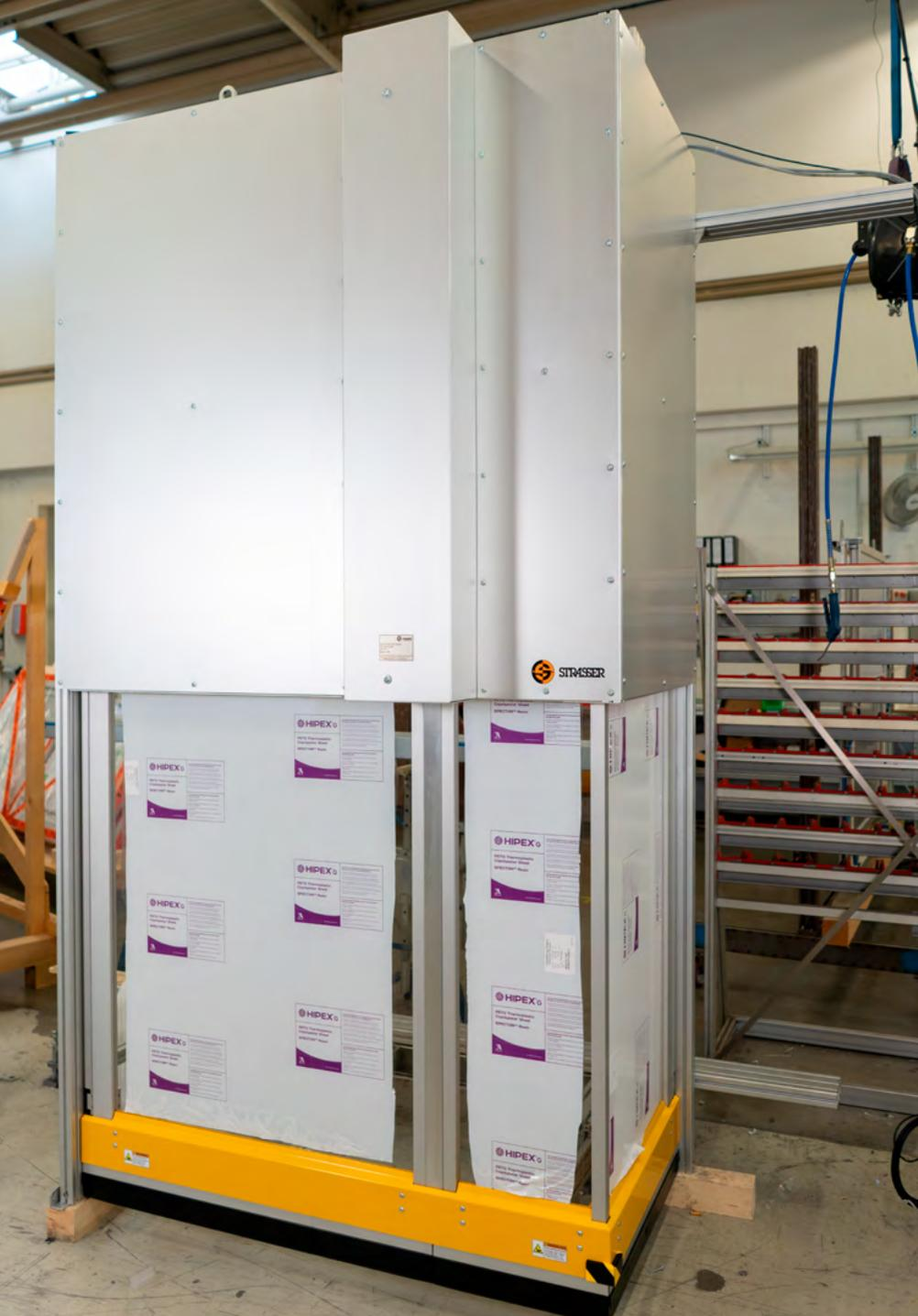
MecLock Vertikal-Schutzfenster SFV.G-B10-E-3600-FO – servoelektrisch angetrieben
