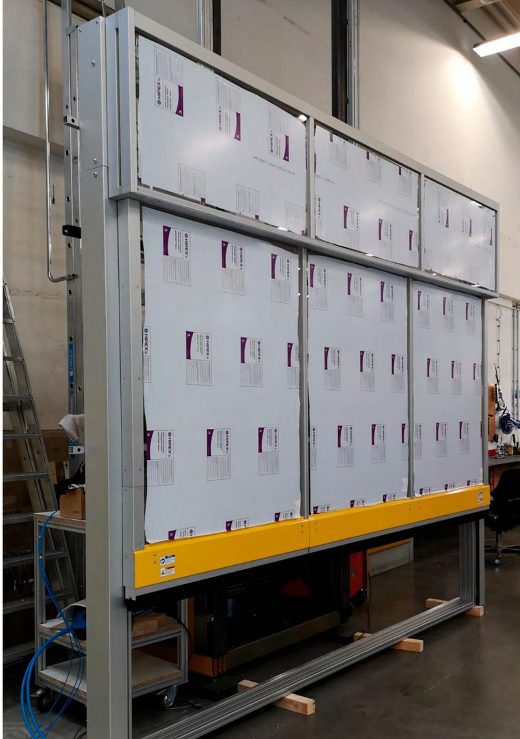
MecLock Vertikal-Schutzfenster SFV.F-B01-P-2350-FM – pneumatisch angetrieben für große Schutzbereiche – mit verkürzter Blende
