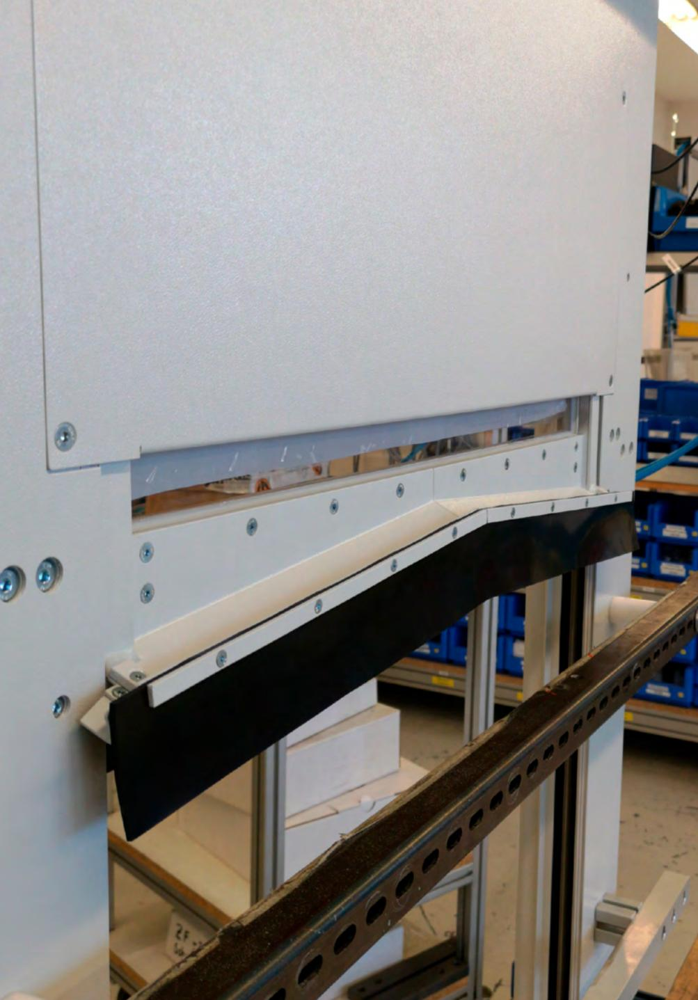
MecLock Vertikal-Schutzfenster SFV.D-B01-P-1500-FM – pneumatisch angetrieben
