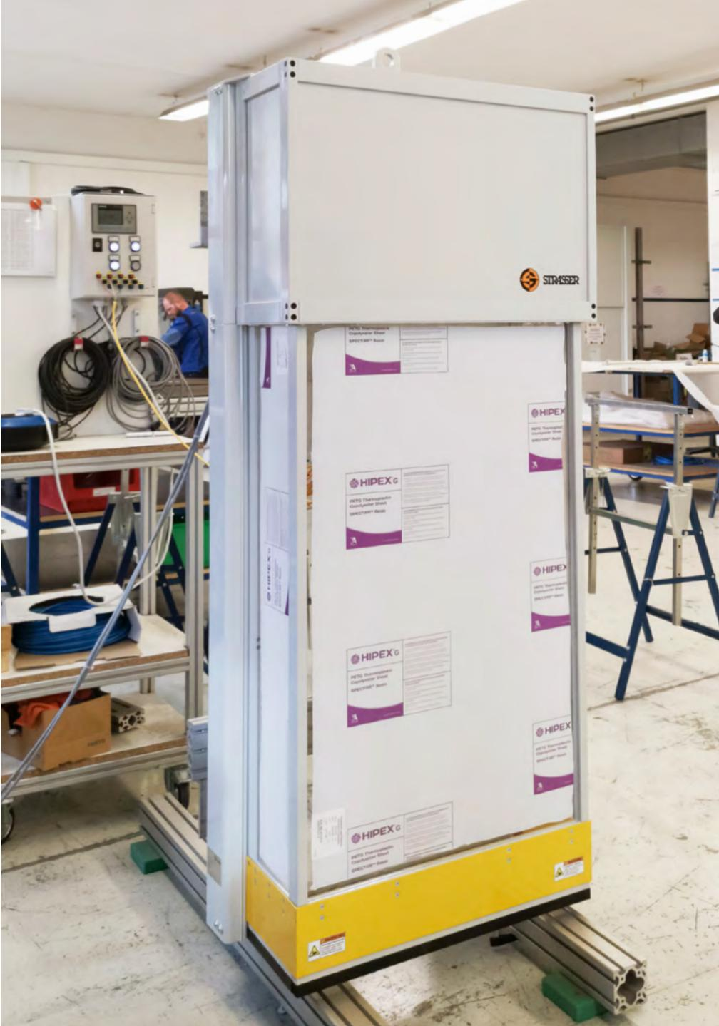
MecLock Vertikal-Schutzfenster SFV.D-B30-E-4000-FOV – servoelektrisch angetrieben
