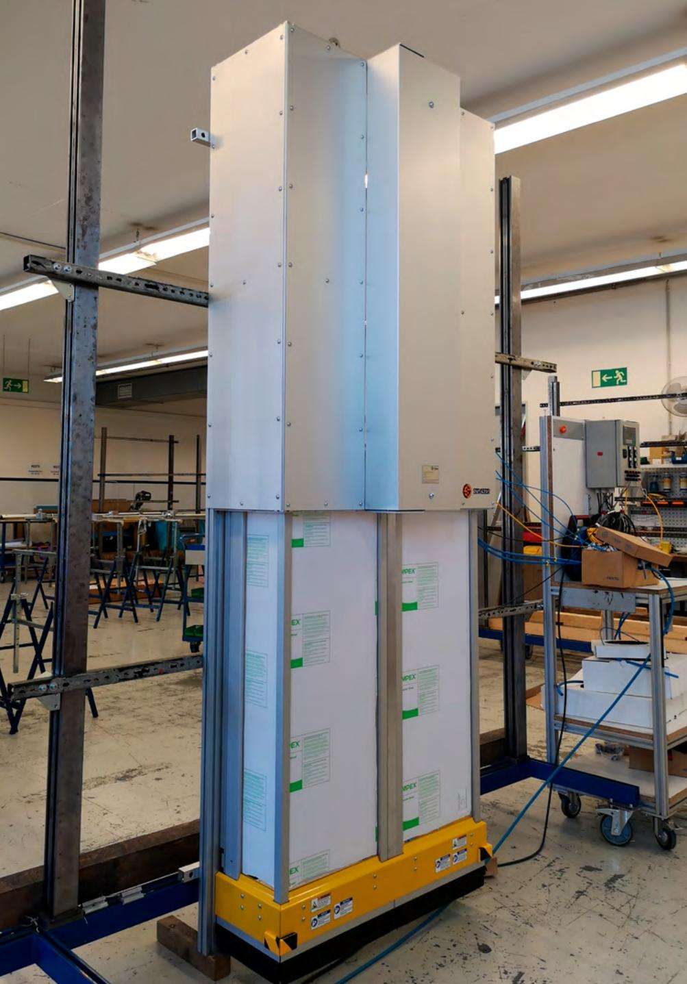
MecLock Vertikal-Schutzfenster SFV.G-B30-P-1175-FO – pneumatisch angetrieben
