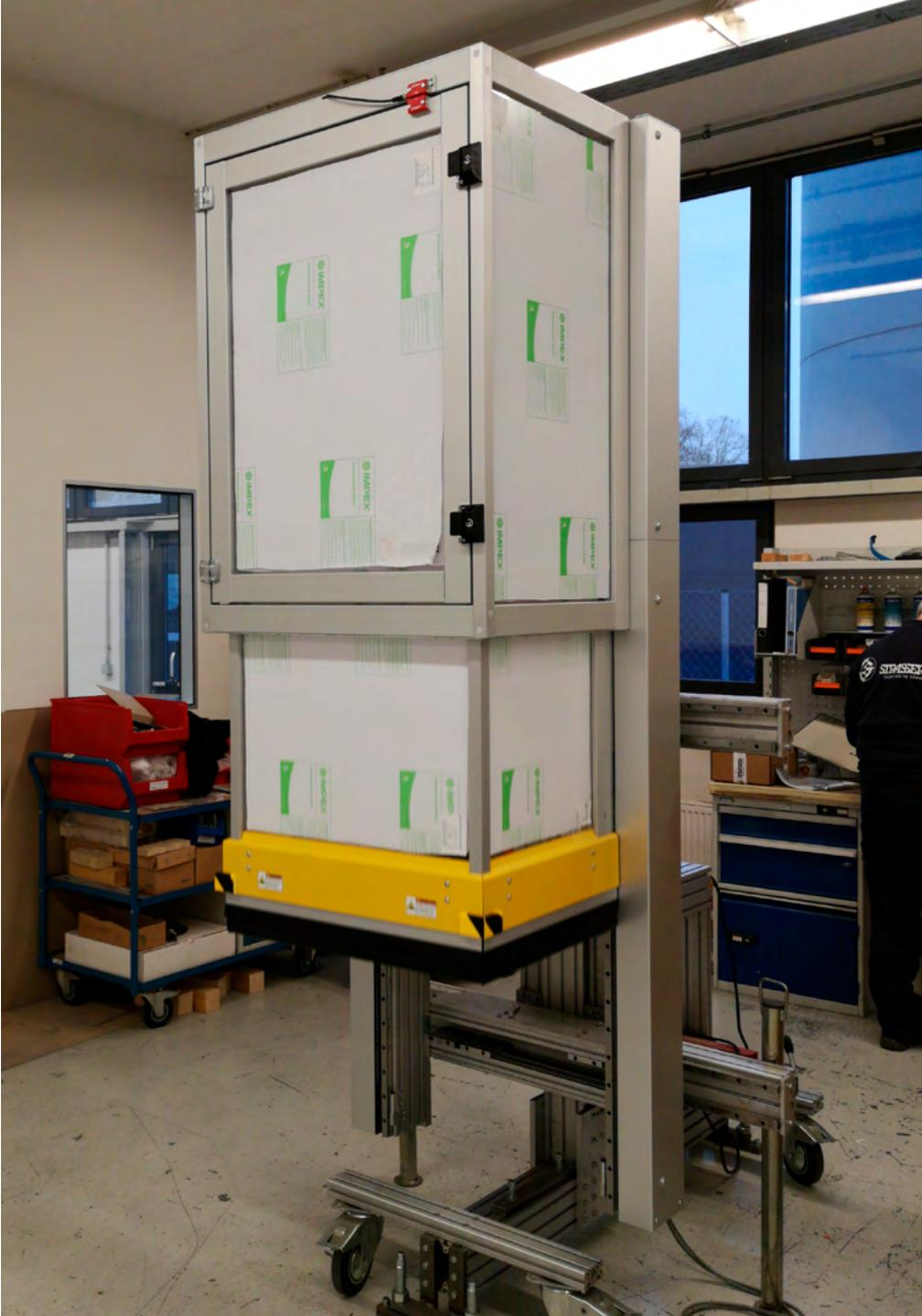
MecLock Vertikal-Schutzfenster SFV.F-B30-E-7200-FO – servoelektrisch angetrieben
