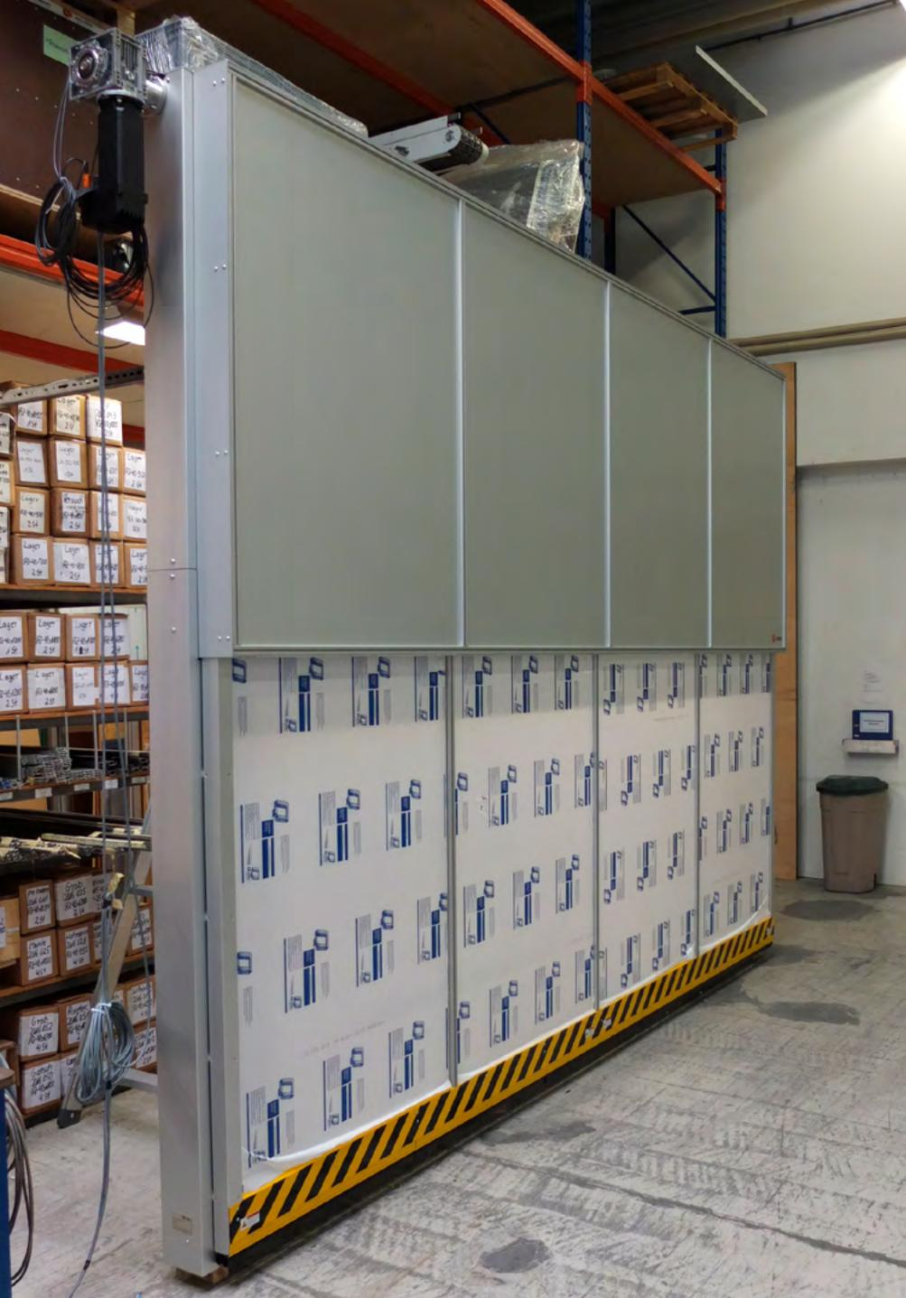
MecLock Vertikal-Schutzfenster SFV.F-B01-E-7200 – servoelektrisch angetrieben für große Schutzbereiche – barrierefreie Beladung mit Flurförderfahrzeug
