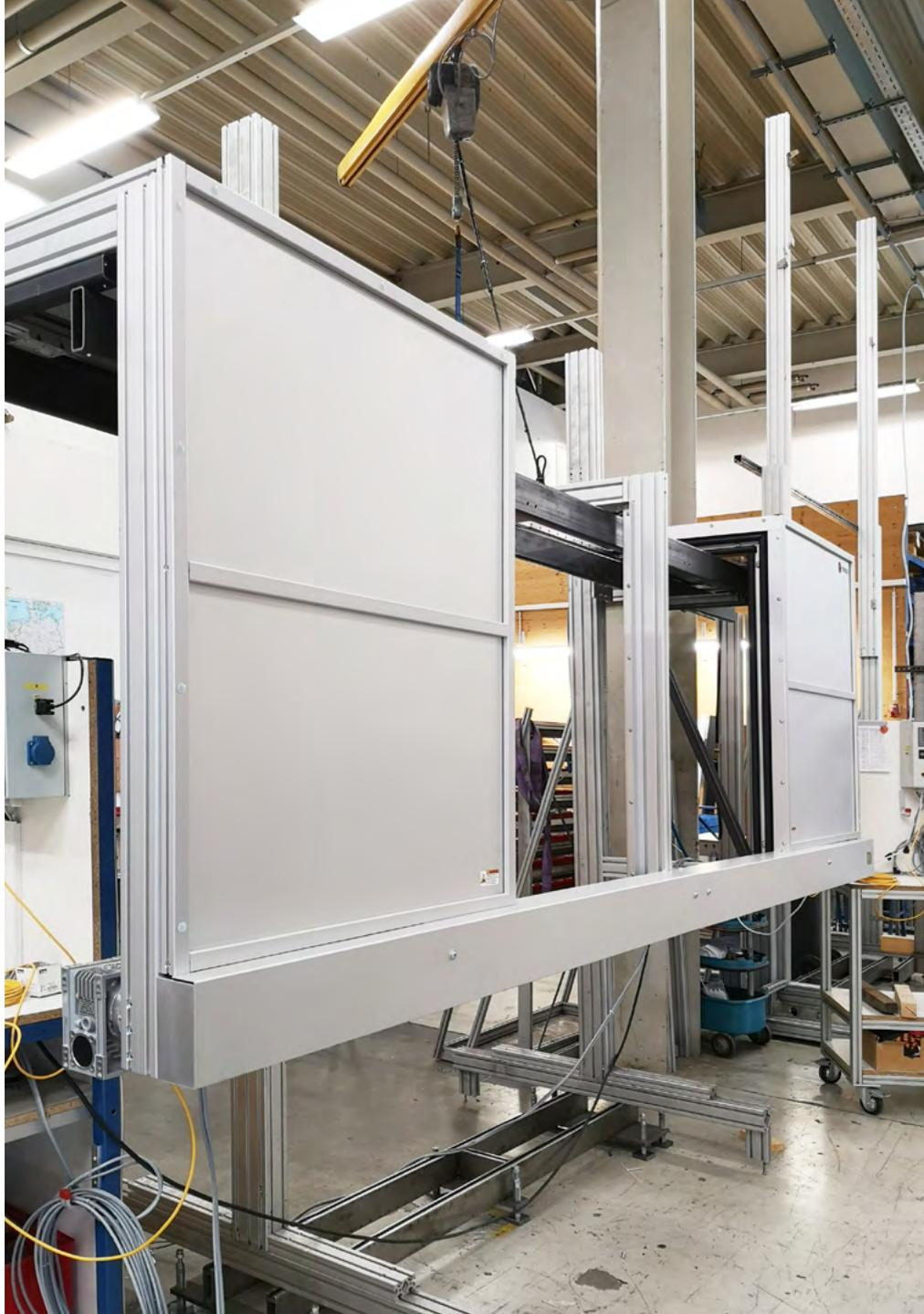
MecLock Horizontal-Schutzfenster SFH.E-B99-E-7200-SA – servoelektrisch angetrieben
