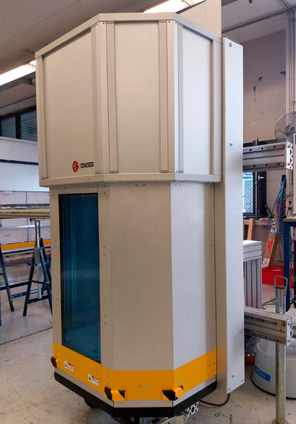
MecLock Vertikal-Schutzfenster SFV.F-B99-E-7200-FO – servoelektrisch angetrieben
