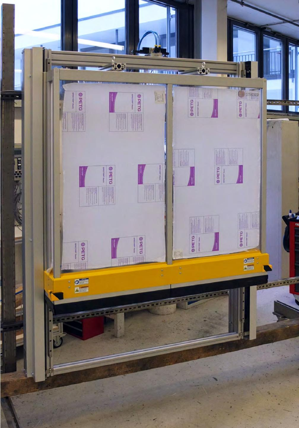
MecLock Vertikal-Schutzfenster SFV.F-B30-P-2350-FO – pneumatisch angetrieben
