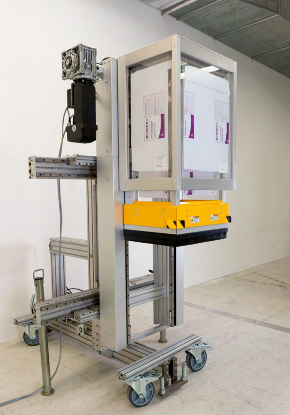
MecLock Vertikal-Schutzfenster SFV.F-B30-E-7200-FO – servoelektrisch angetrieben
