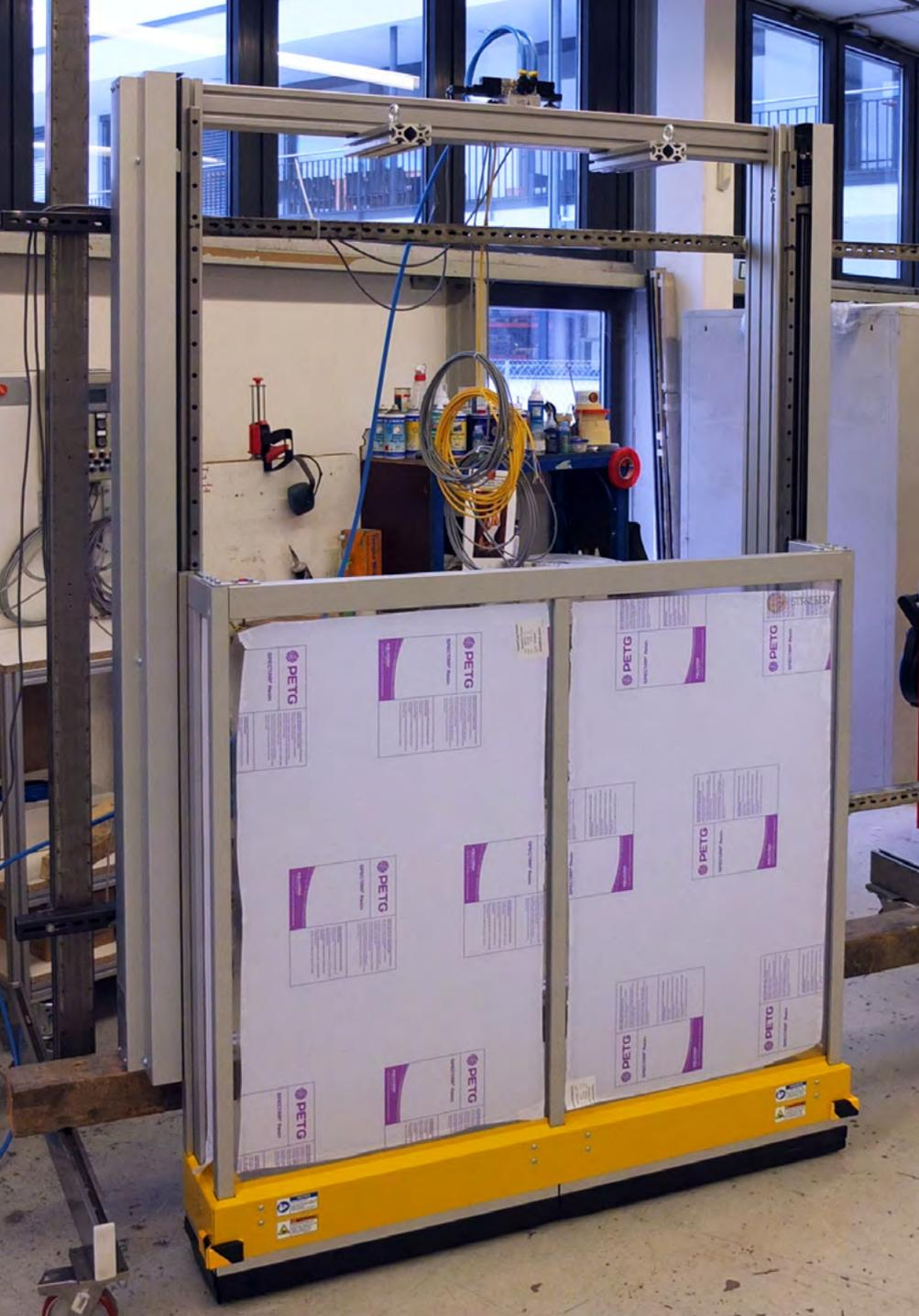
MecLock Vertikal-Schutzfenster SFV.F-B30-P-2350-FO – pneumatisch angetrieben
