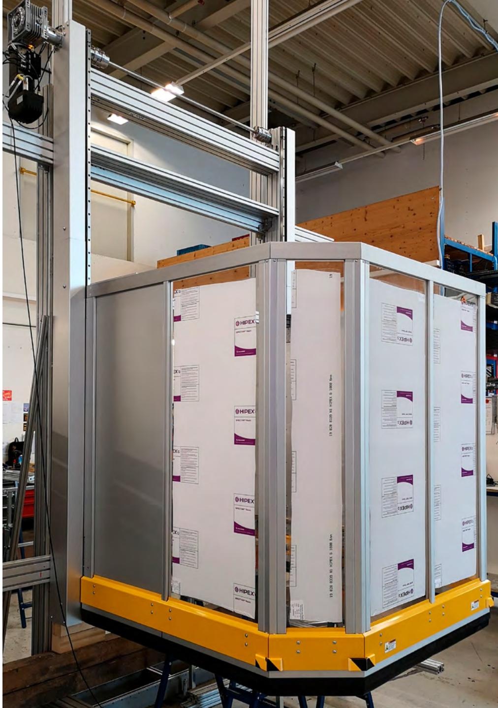
MecLock Vertikal-Schutzfenster SFV.F-B99-E-7200-FO – servoelektrisch angetrieben
