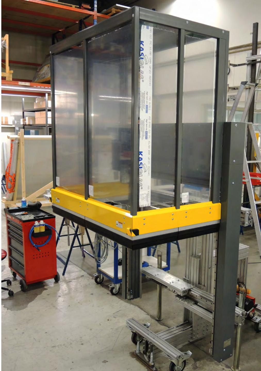
MecLock Vertikal-Schutzfenster SFV.F-B30-E-7200-FO – servoelektrisch angetrieben
