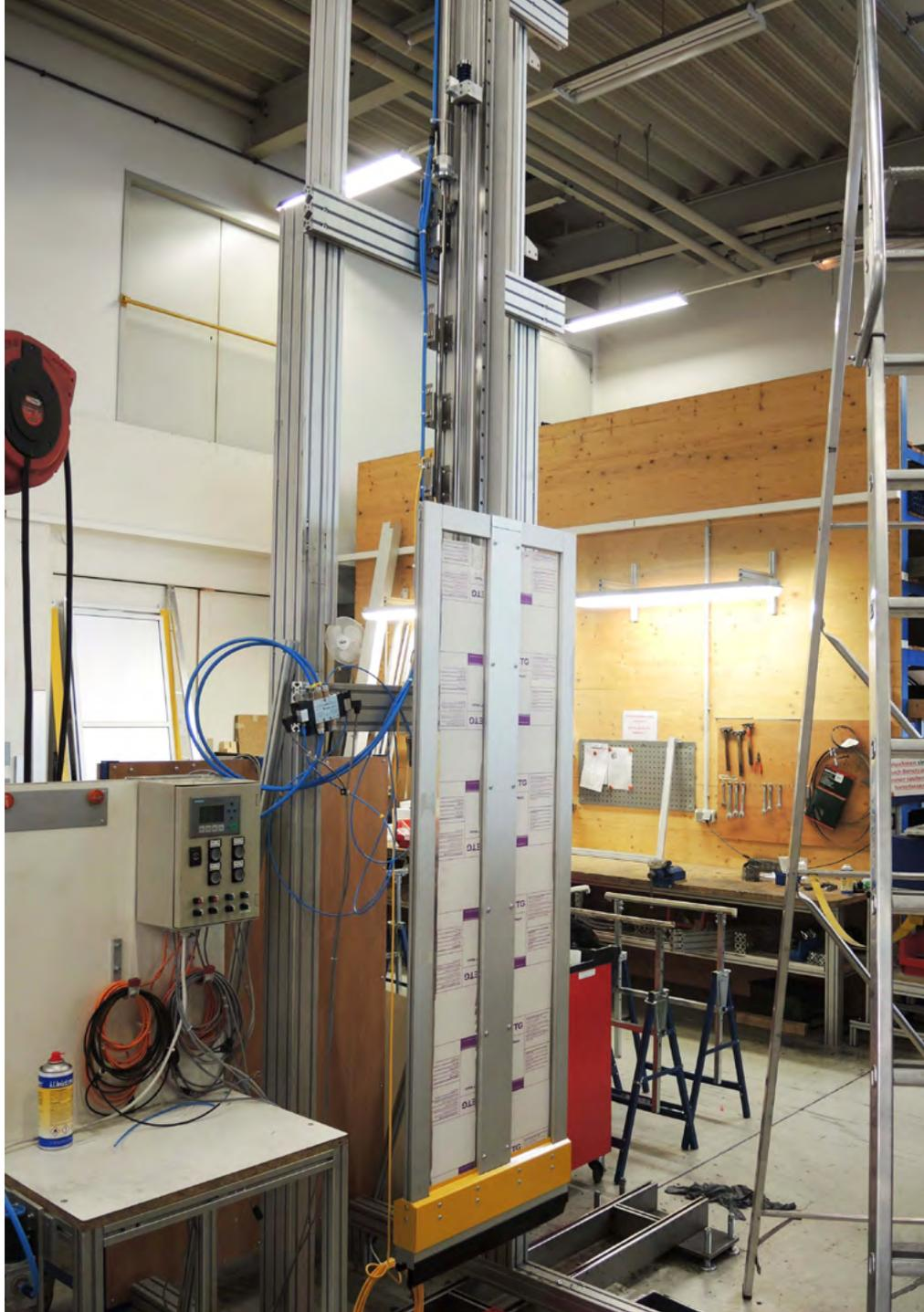
MecLock Vertikal-Schutzfenster SFV.F-B99-P-1175-FO – pneumatisch angetrieben
