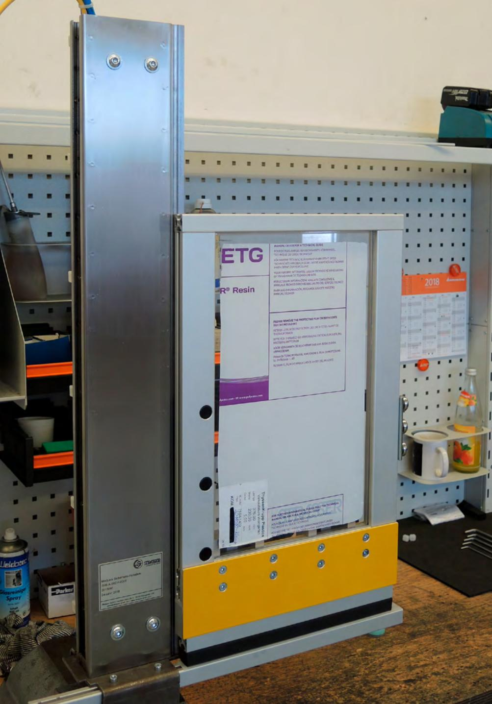
MecLock Sicherheits-Hubsäule SHS.A – pneumatisch angetrieben
