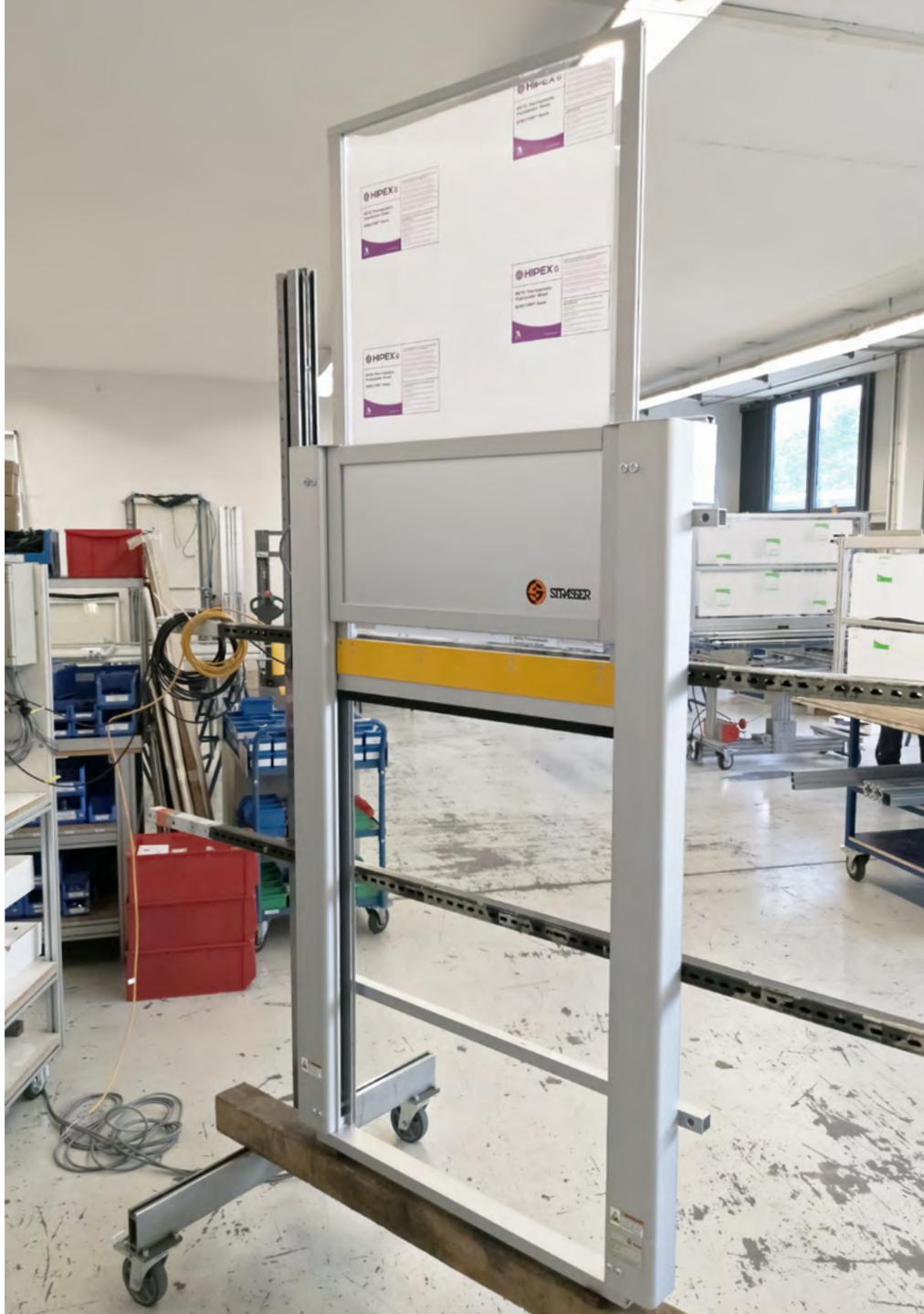
MecLock Vertikal-Schutzfenster SFV.D-B01-E-4000-FOV – servoelektrisch angetrieben ohne Querprofil unten – mit verkürzter Blende oben – geöffnete Endlage
