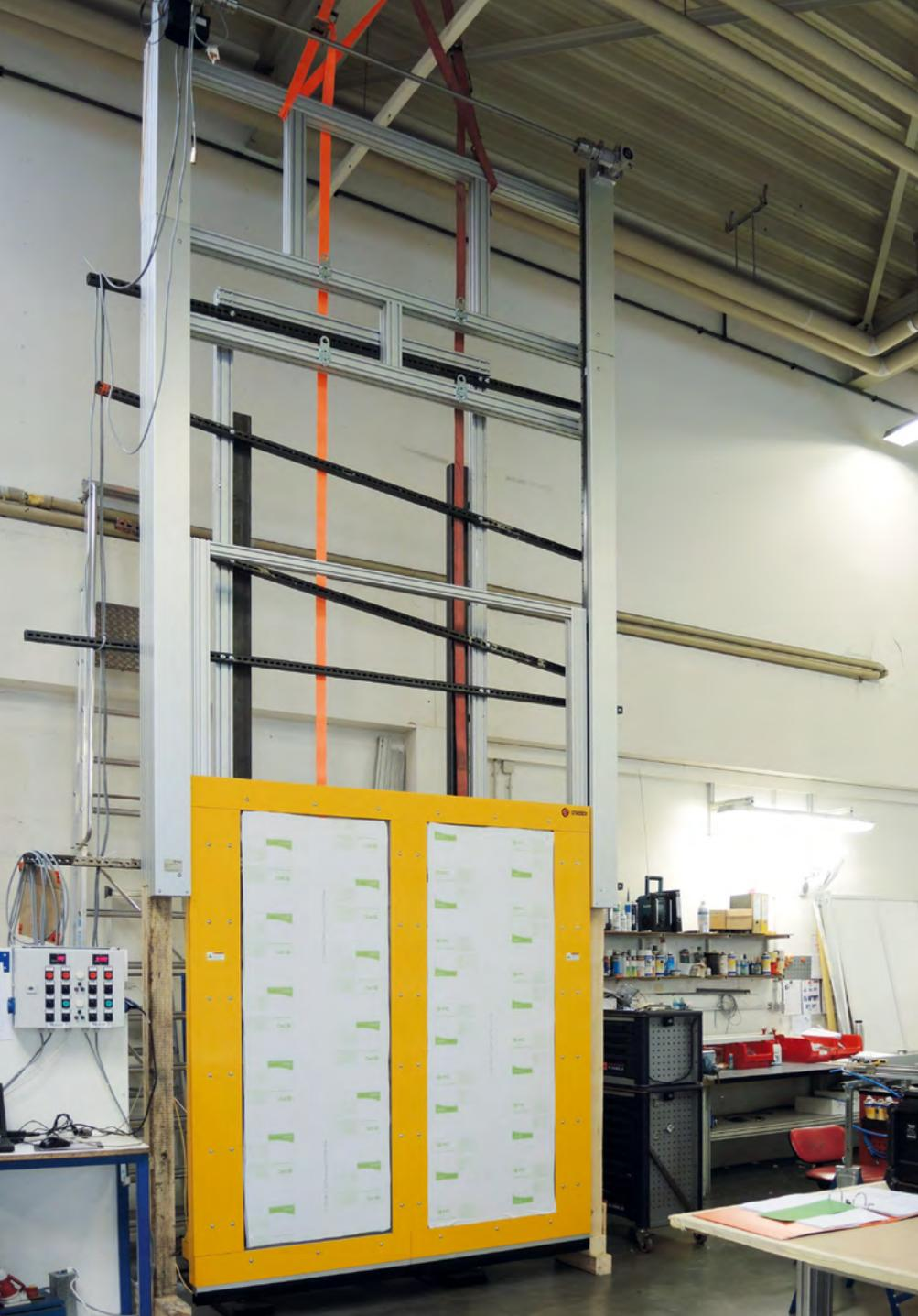
MecLock Vertikal-Schutzfenster SFV.F-B99-E-7200-FO – servoelektrisch angetrieben
