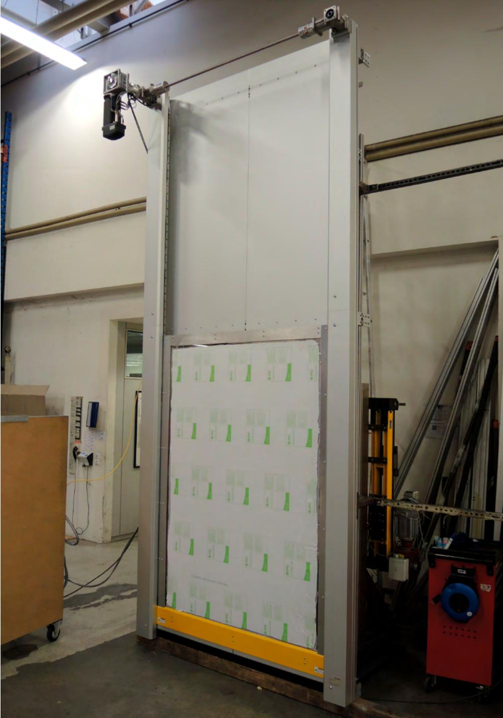
MecLock Vertikal-Schutzfenster SFV.F-B99-E-7200-FO – servoelektrisch angetrieben
