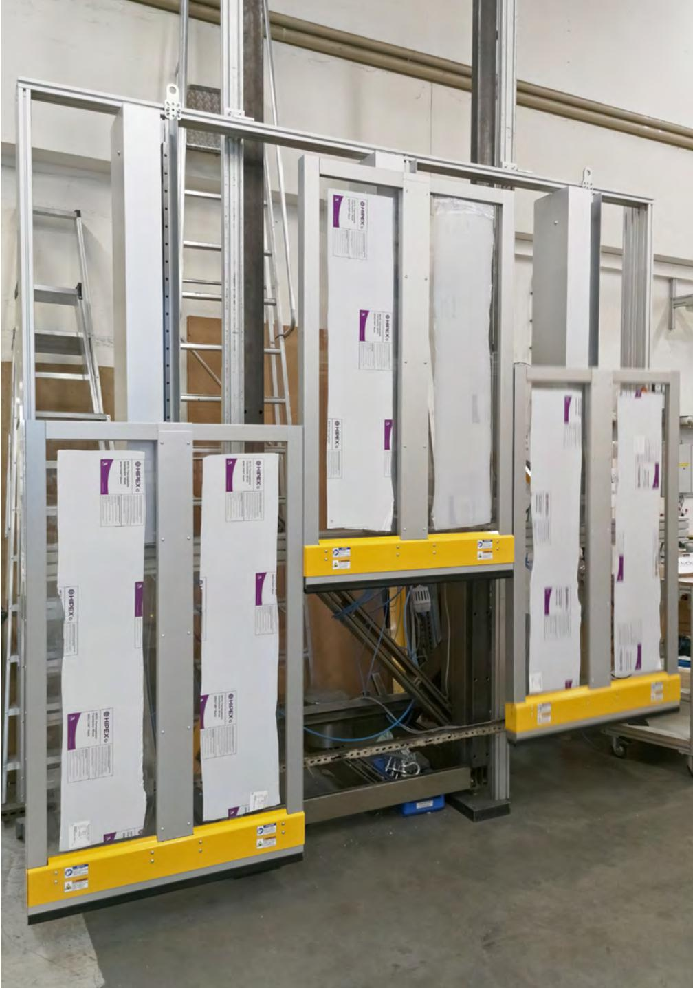
MecLock Vertikal-Schutzfenster SFV.G-B99-P – pneumatisch angetrieben
