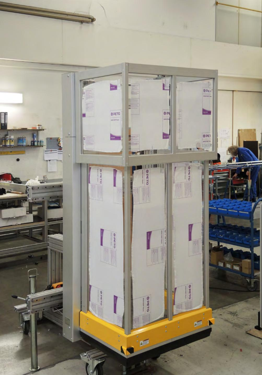
MecLock Vertikal-Schutzfenster SFV.F-B30-P-2350-FO – pneumatisch angetrieben
