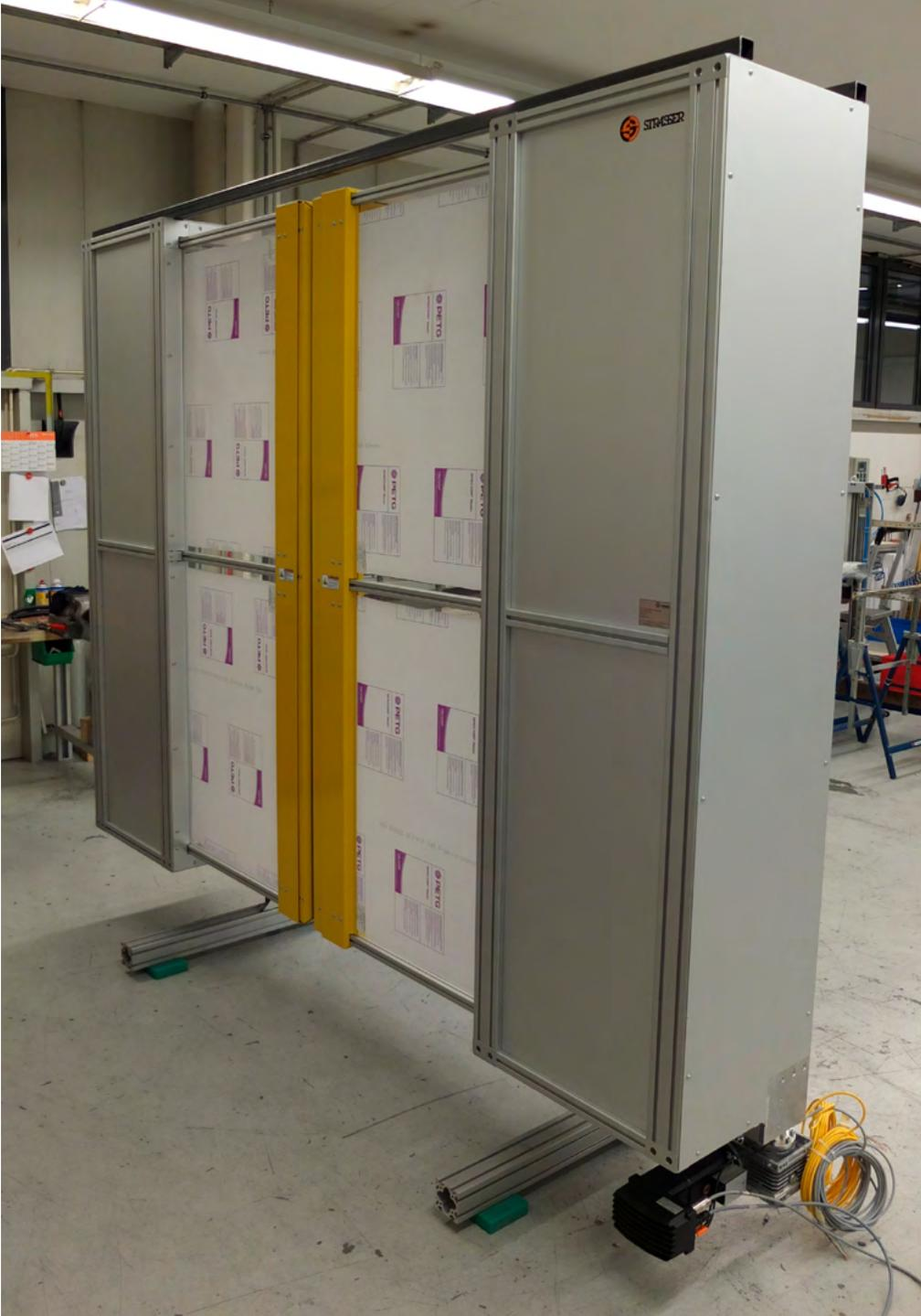
MecLock Horizontal-Schutzfenster SFH.E-B99-E-3600 – servoelektrisch angetrieben
