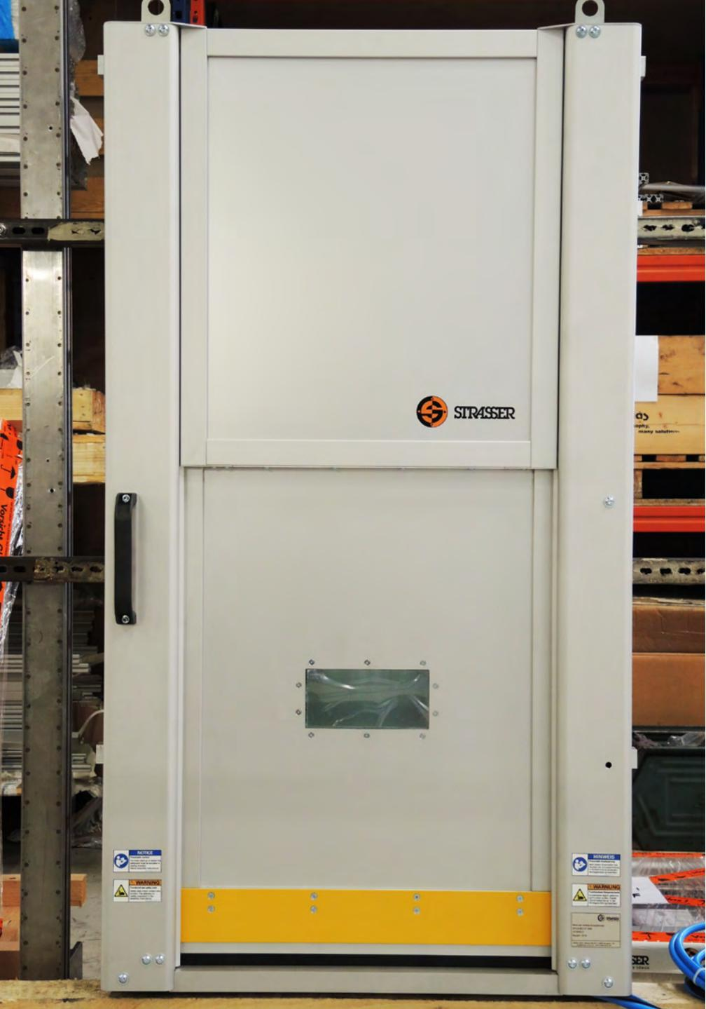
MecLock Vertikal-Schutzfenster SFV.D-B01-P-1500-FM – pneumatisch angetrieben mit Prozessfenster – auf Schwenkrahmen für barrierefreien Zugang zur Maschine
