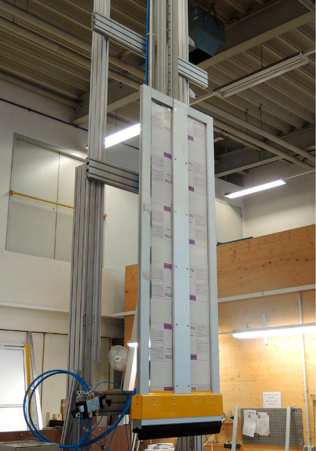
MecLock Vertikal-Schutzfenster SFV.F-B99-P-1175-FO – pneumatisch angetrieben
