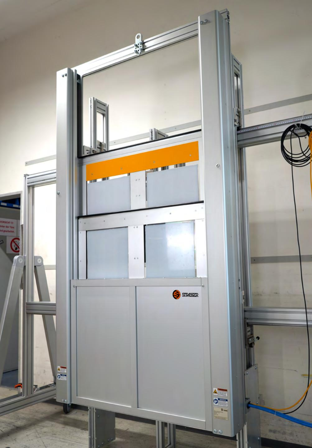
MecLock Vertikal-Schutzfenster SFV.D-B01-P-1500 – pneumatisch angetrieben mit teleskopierendem Scheibenrahmen – Schließrichtung von unten nach oben mit Querprofil oben – mit hinterfahrbarer Kontaktleiste
