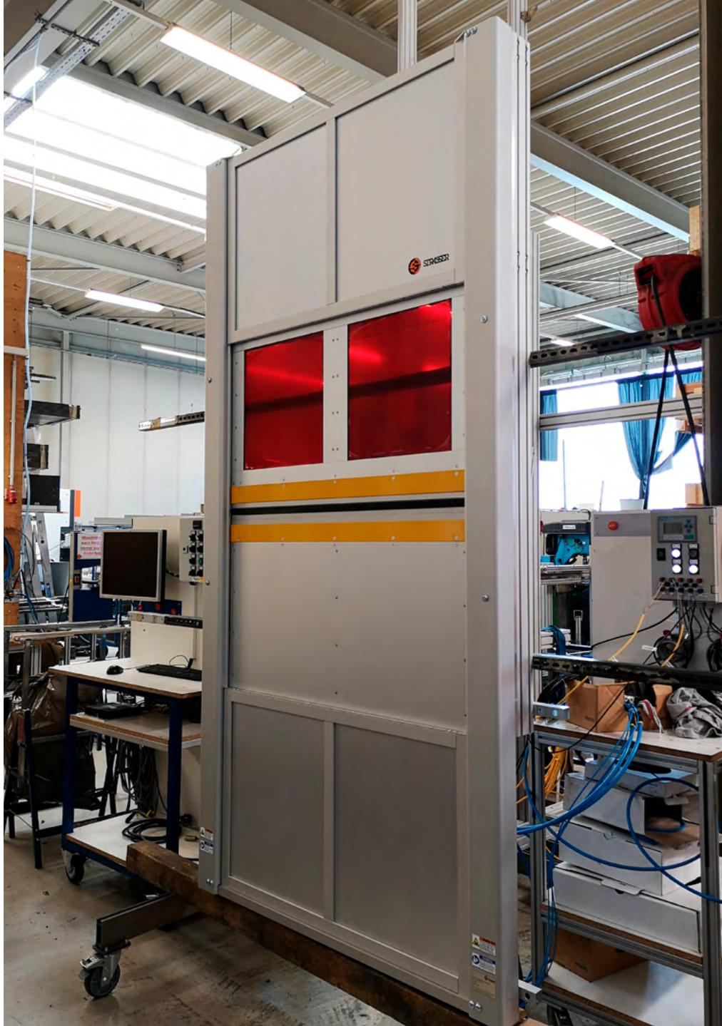
MecLock Vertikal-Schutzfenster SFV.D-B01-P-1500-FM-...-FS21 – pneumatisch angetrieben
