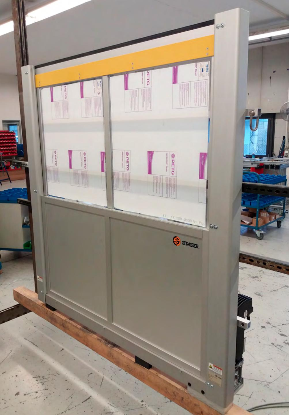
MecLock Vertikal-Schutzfenster SFV.D-B01-E-4000-FO – servoelektrisch angetrieben
