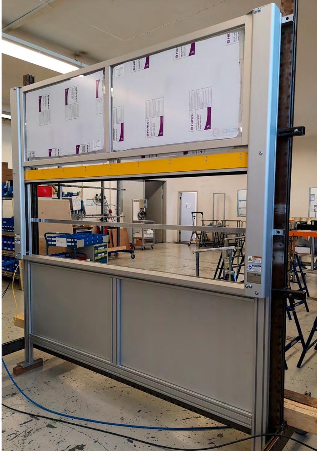
MecLock Vertikal-Schutzfenster SFV.D-B01-P-1500-SM – pneumatisch angetrieben
