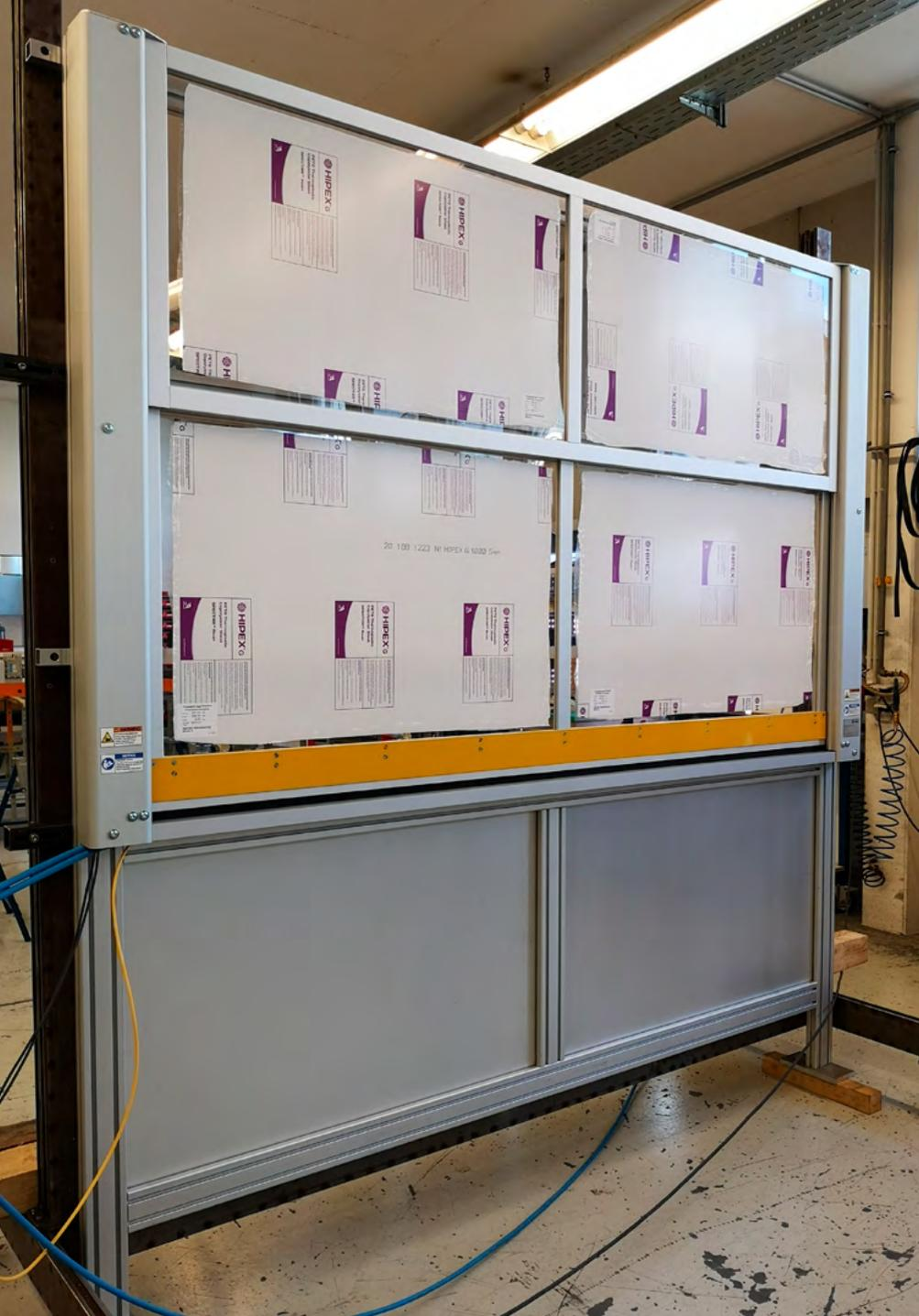
MecLock Vertikal-Schutzfenster SFV.D-B01-P-1500-SM – pneumatisch angetrieben
