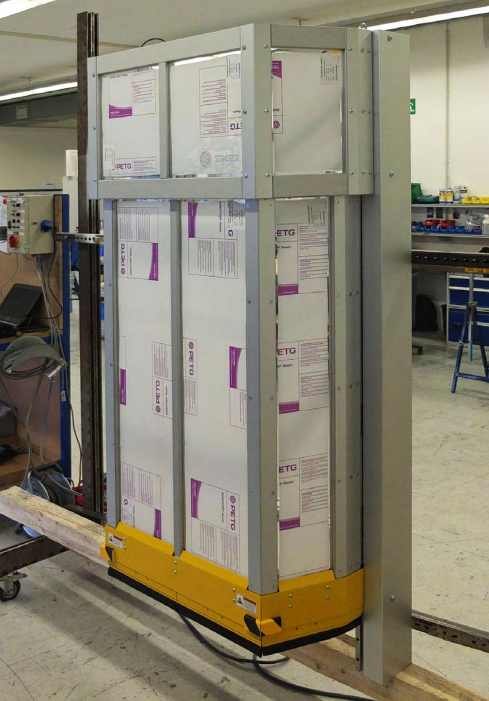
MecLock Vertikal-Schutzfenster SFV.F-B99-E-7200-FO – servoelektrisch angetrieben
