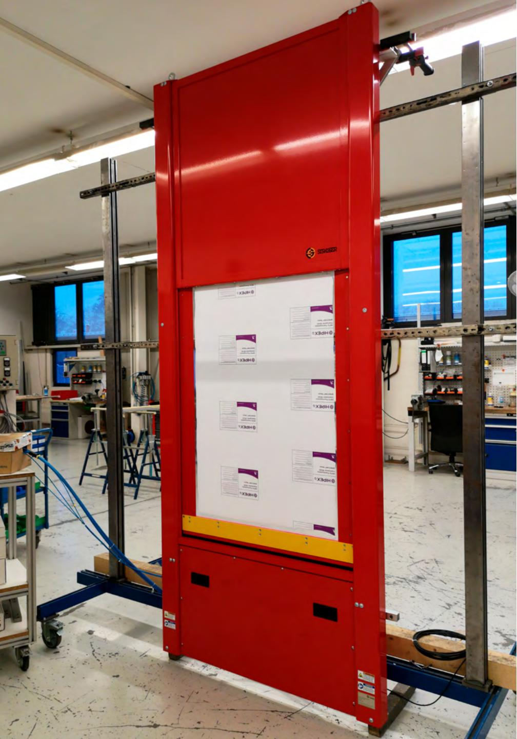
MecLock Vertikal-Schutzfenster SFV.D-B01-P-1500-FMV – pneumatisch angetrieben
