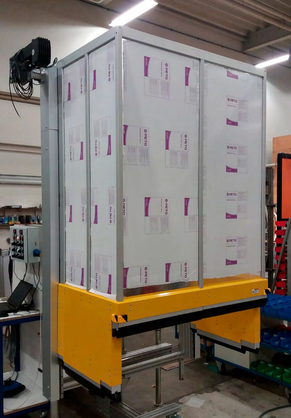
MecLock Vertikal-Schutzfenster SFV.F-B30-E-7200-FO – servoelektrisch angetrieben
