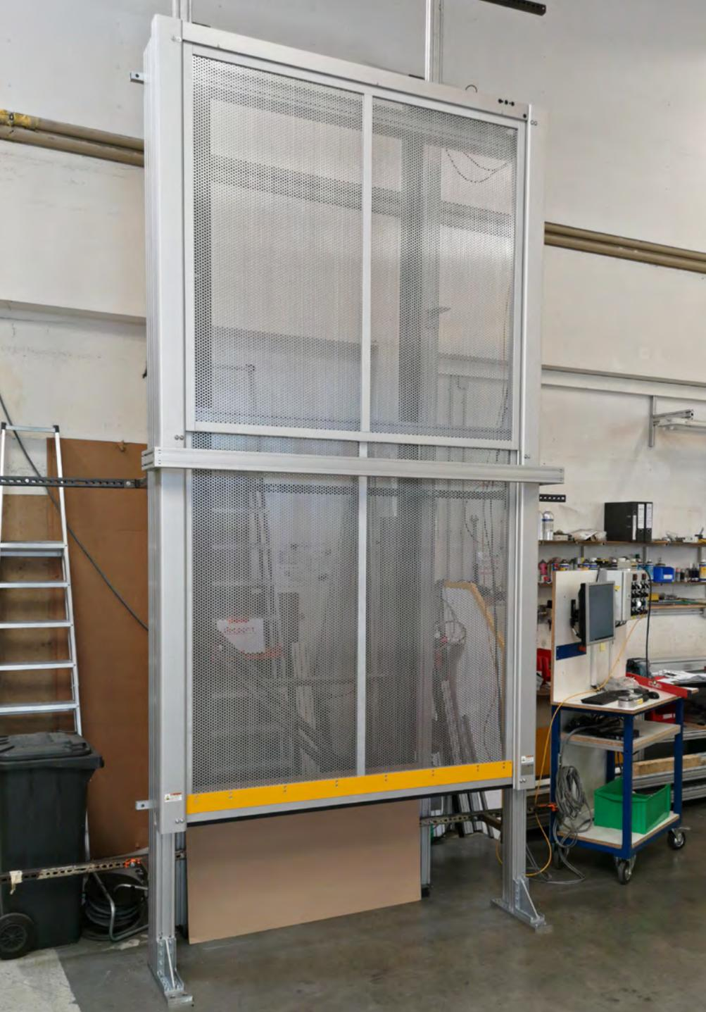
MecLock Vertikal-Schutzfenster SFV.D-B01-E-4000 – servoelektrisch angetrieben
