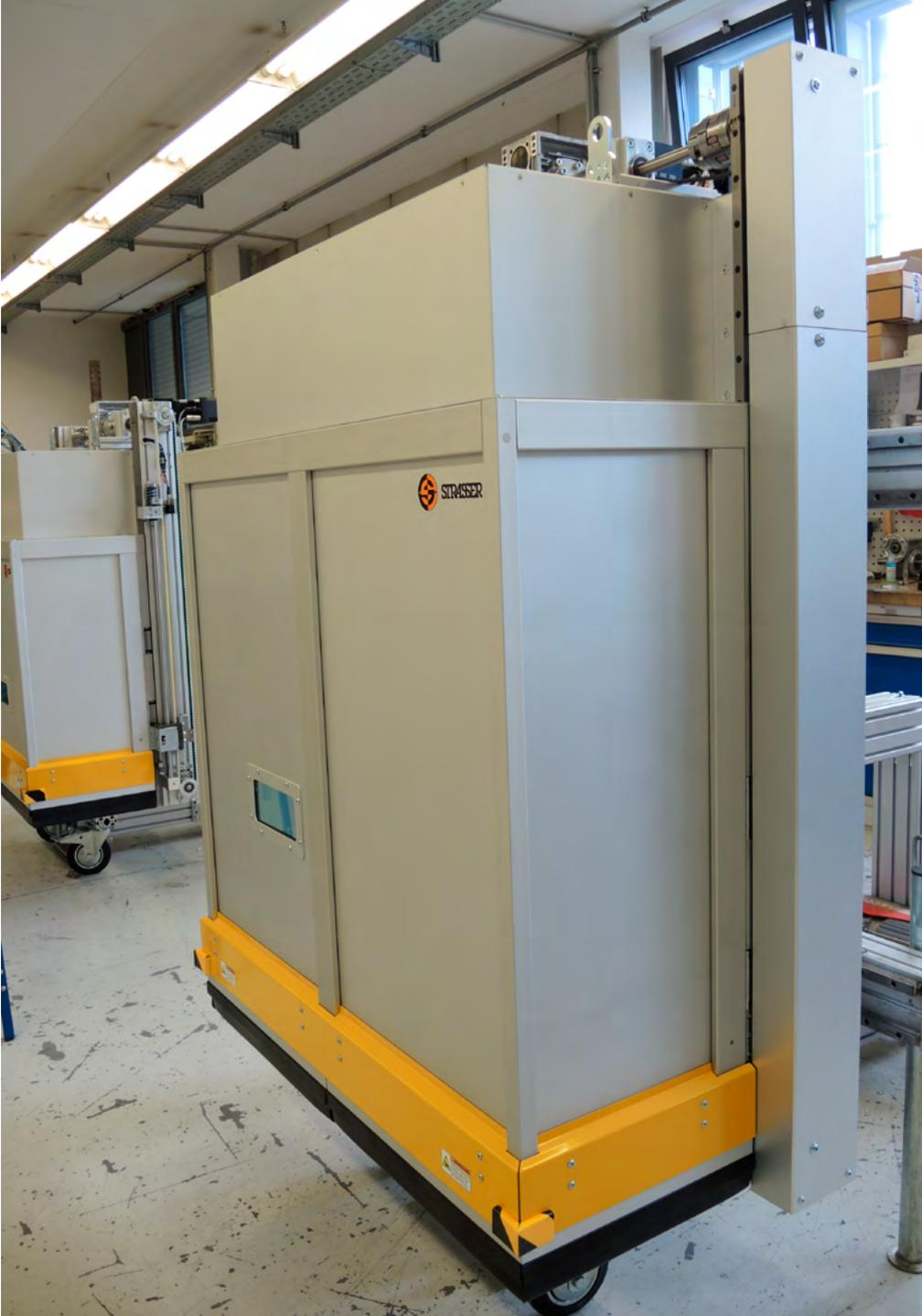
MecLock Vertikal-Schutzfenster SFV.F-B99-E-7200-FO – servoelektrisch angetrieben
