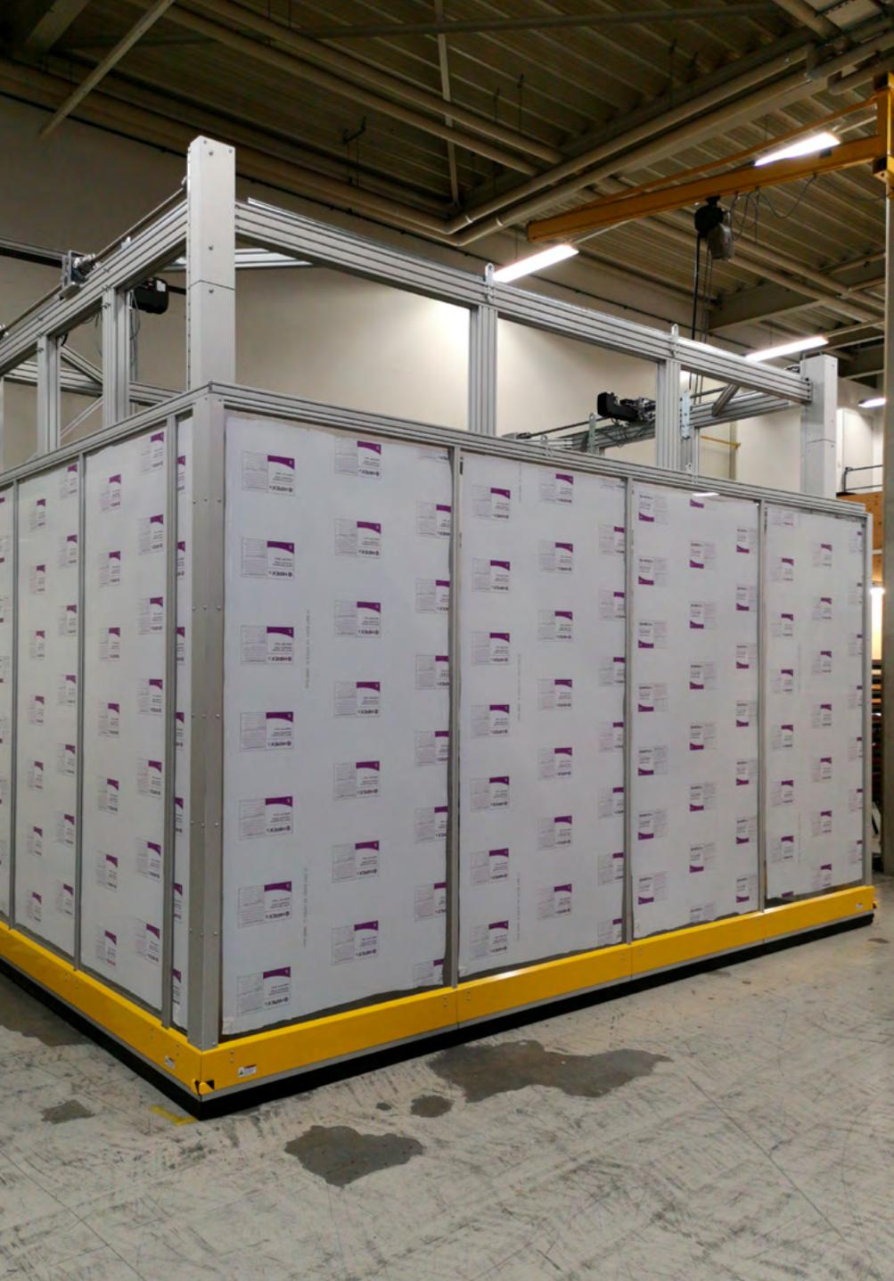
MecLock Vertikal-Schutzfenster SFV.F-B99-E-14400-FO – servoelektrisch angetrieben
