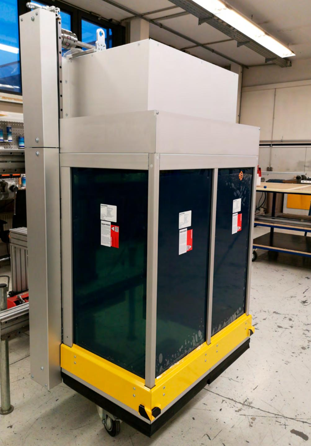
MecLock Vertikal-Schutzfenster SFV.F-B99-E-7200-FO – servoelektrisch angetrieben
