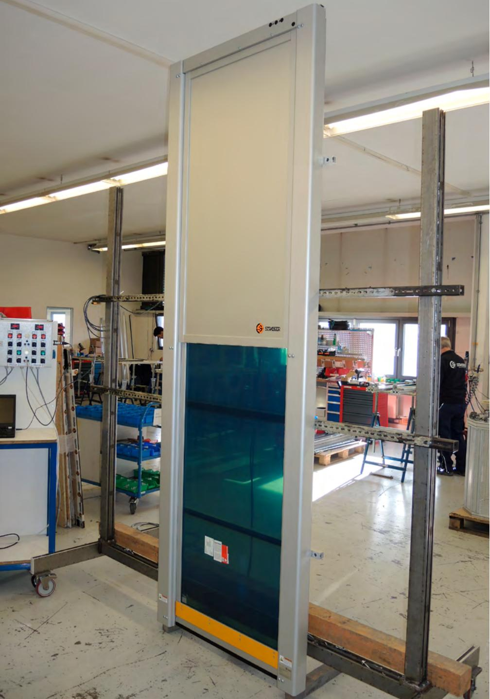
MecLock Vertikal-Schutzfenster SFV.D-B01-E-4000-FO – servoelektrisch angetrieben
