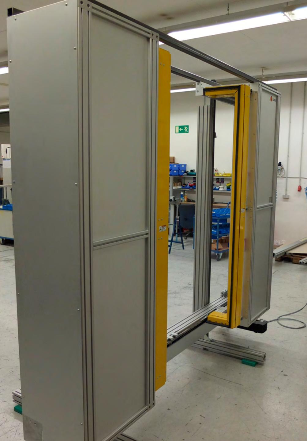
MecLock Horizontal-Schutzfenster SFH.E-B99-E-3600 – servoelektrisch angetrieben
