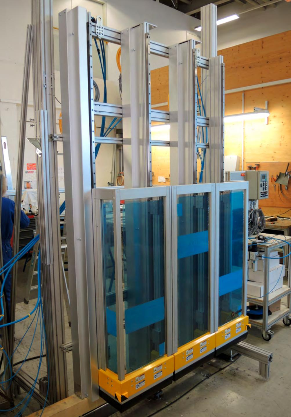
MecLock Vertikal-Schutzfenster SFV.F-B99-P-1175-FO – pneumatisch angetrieben
