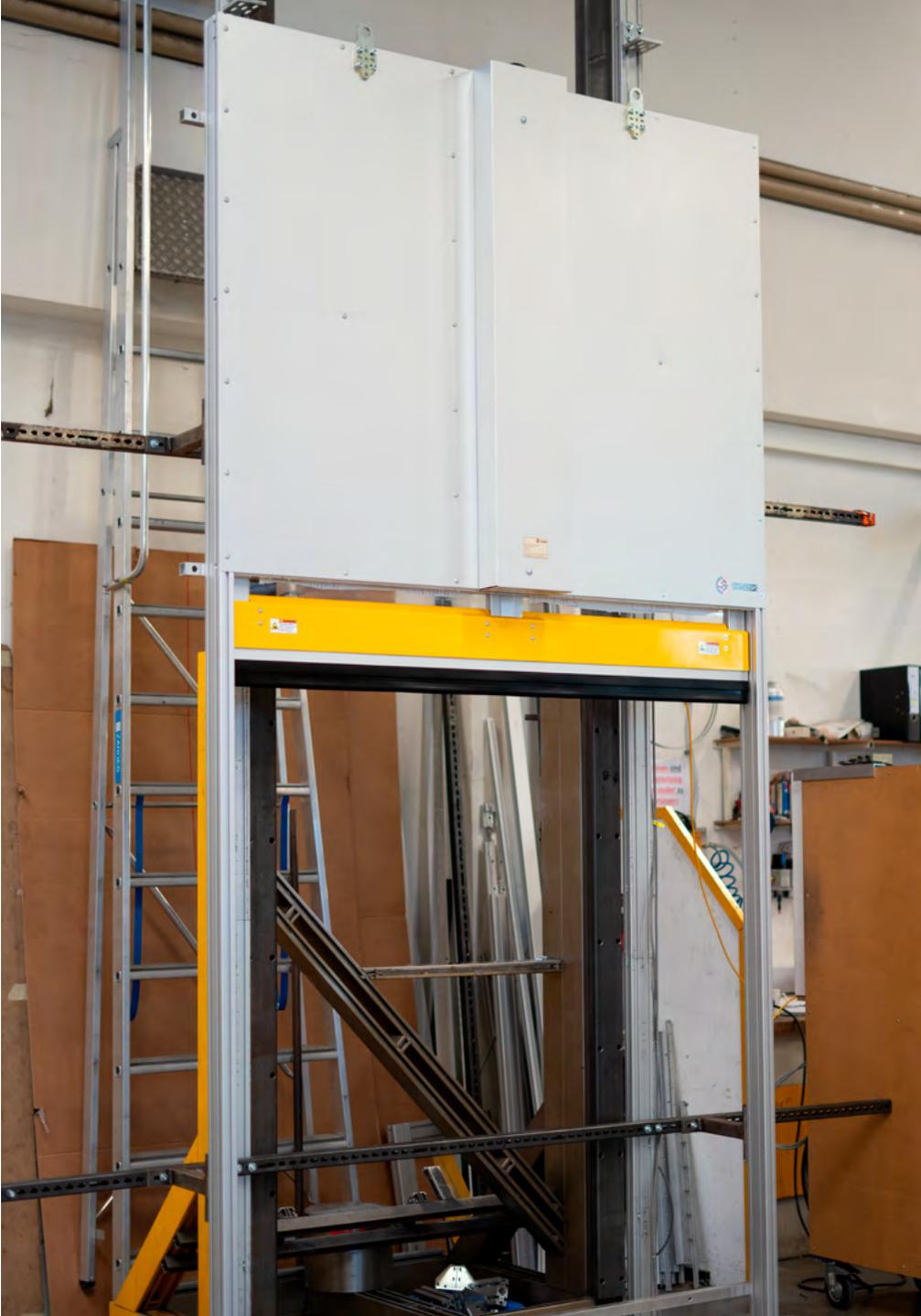
MecLock Vertikal-Schutzfenster SFV.G-B01-E-3600-SO – servoelektrisch angetrieben
