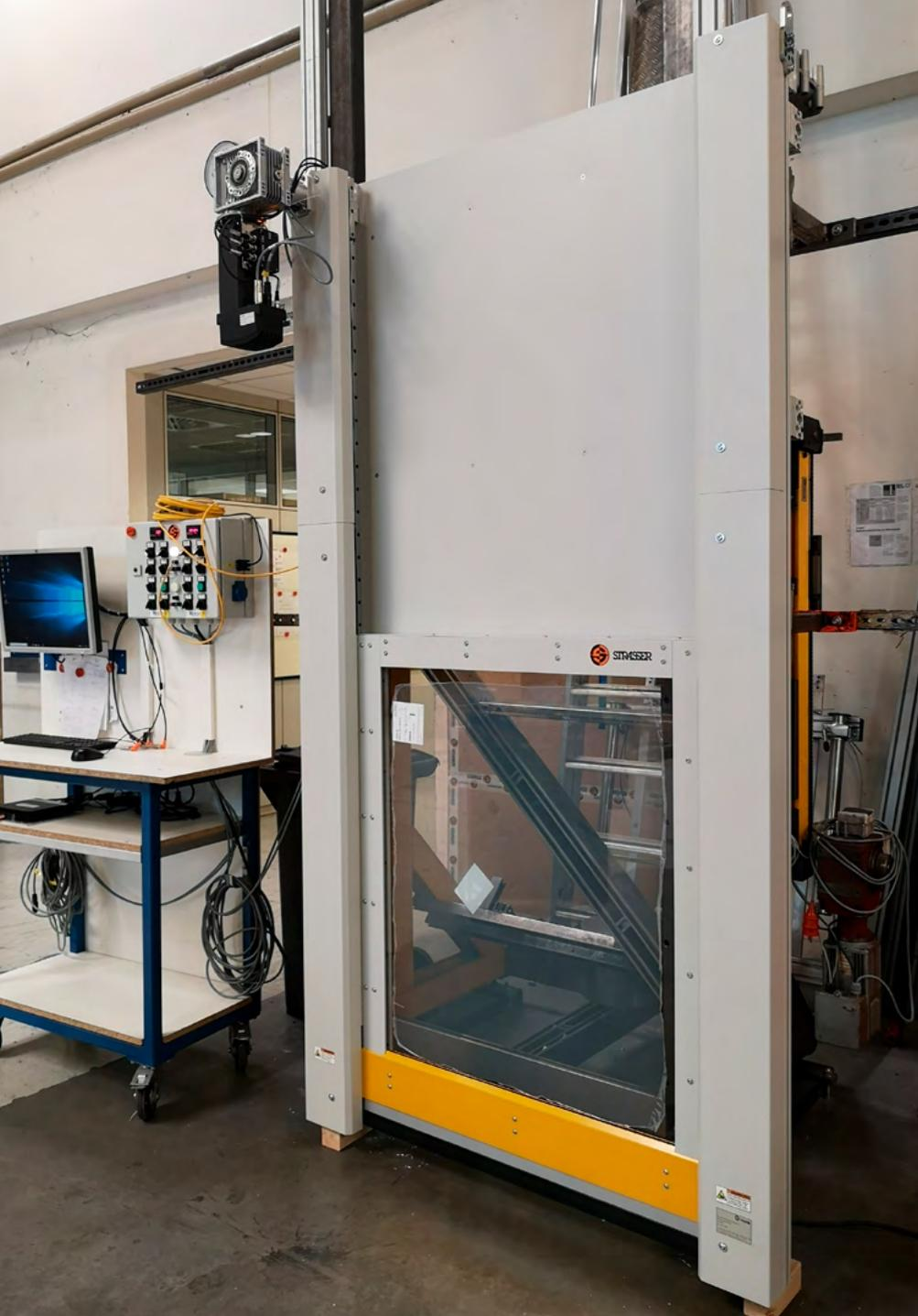
MecLock Vertikal-Schutzfenster SFV.F-B99-E-7200-FO – servoelektrisch angetrieben für Hydraulikprüfstand – verstärkter Scheibenrahmen mit Panzerglasscheibe 25 mm
