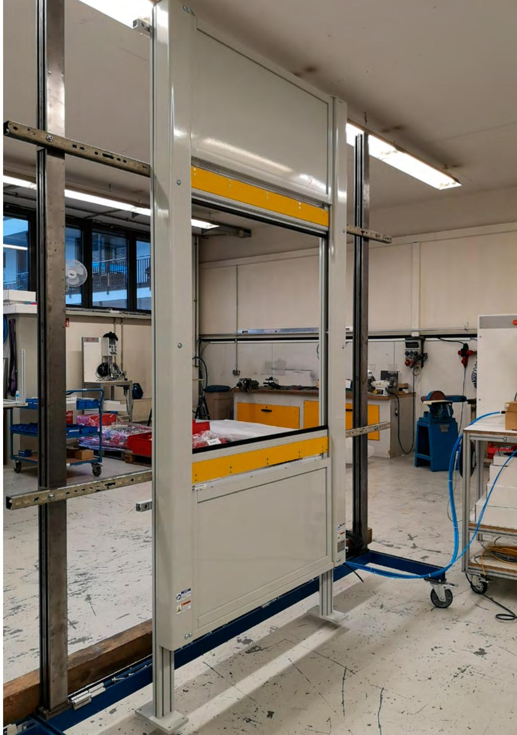
MecLock Vertikal-Schutzfenster SFV.D-B01-P-1500-FM-...-FS21 – pneumatisch angetrieben
