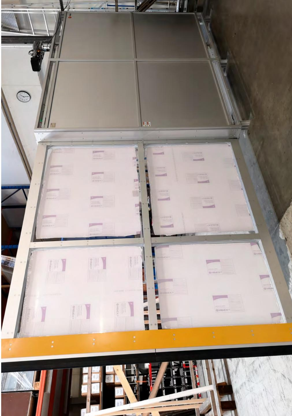
MecLock Horizontal-Schutzfenster SFH.E-B99-E – servoelektrisch angetrieben
