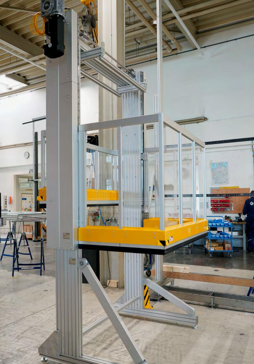
MecLock Vertikal-Schutzfenster – servoelektrisch angetrieben
