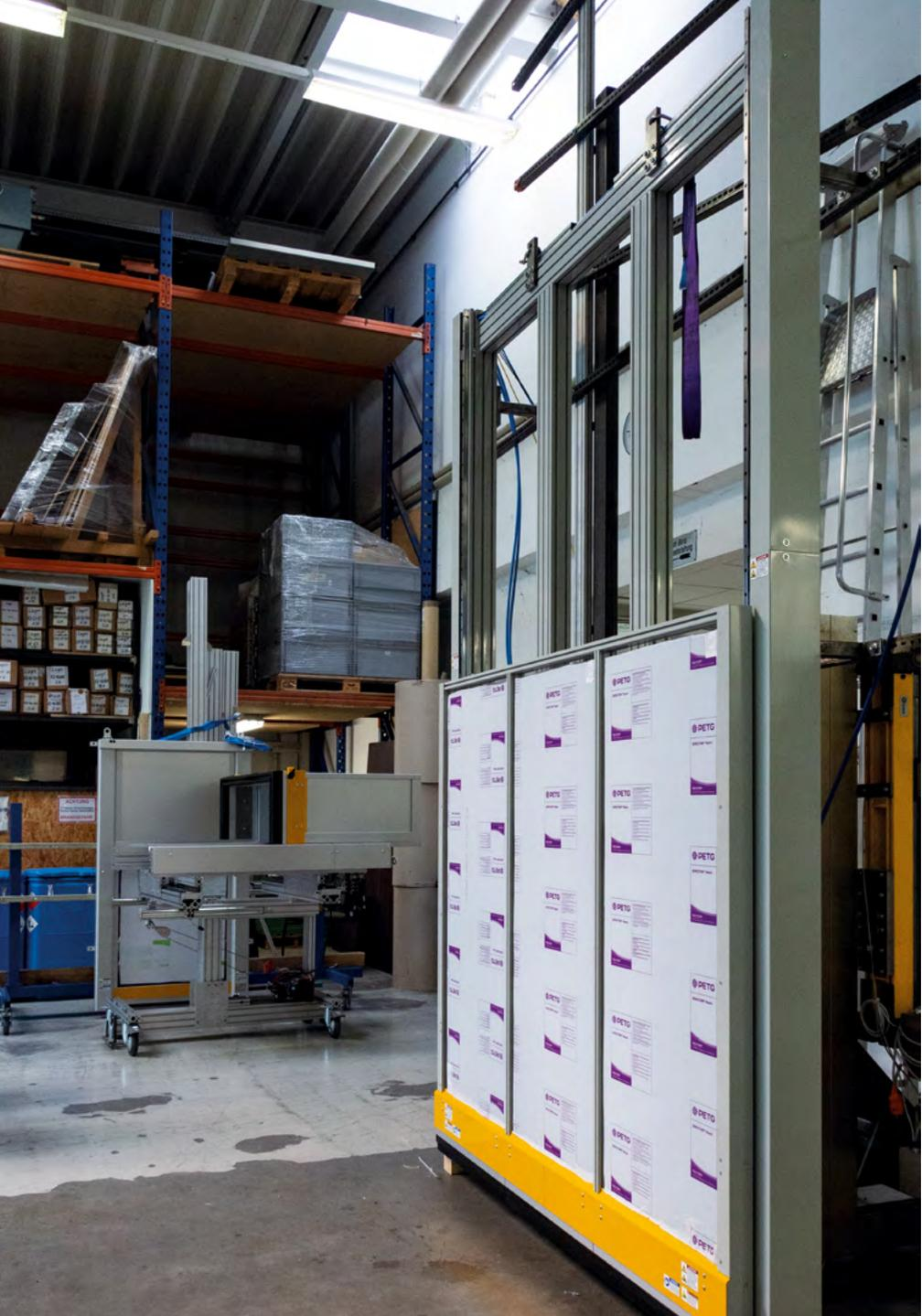
MecLock Vertikal-Schutzfenster SFV.F-B01-P-2350-FM – pneumatisch angetrieben für große Schutzbereiche – ohne Blende oben
