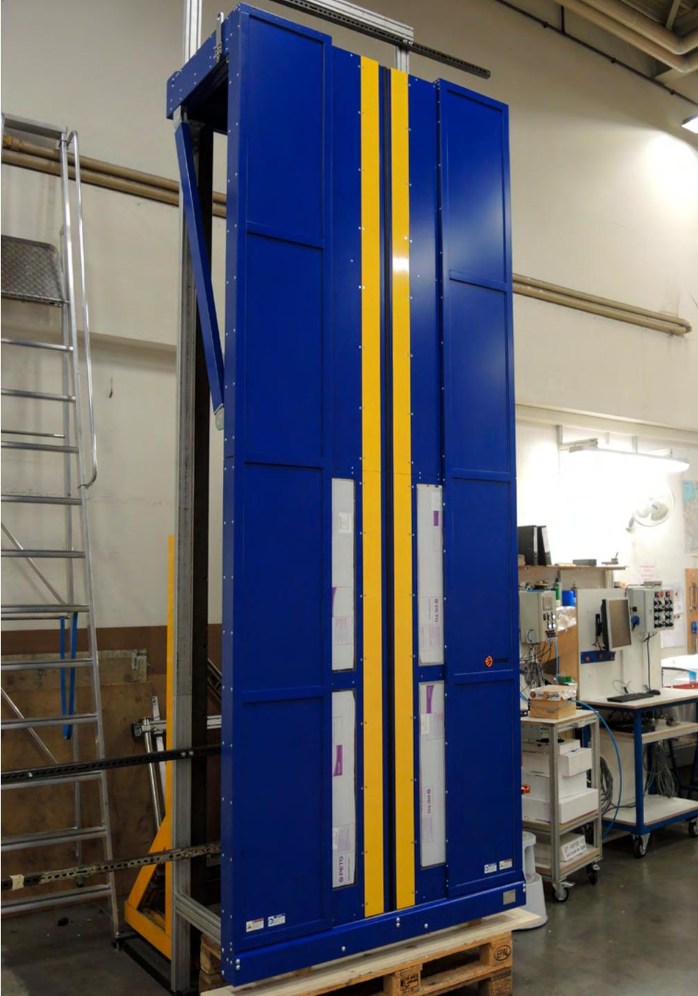
MecLock Horizontal-Schutzfenster SFH.E-B99-P-1500-FK-SA – pneumatisch angetrieben
