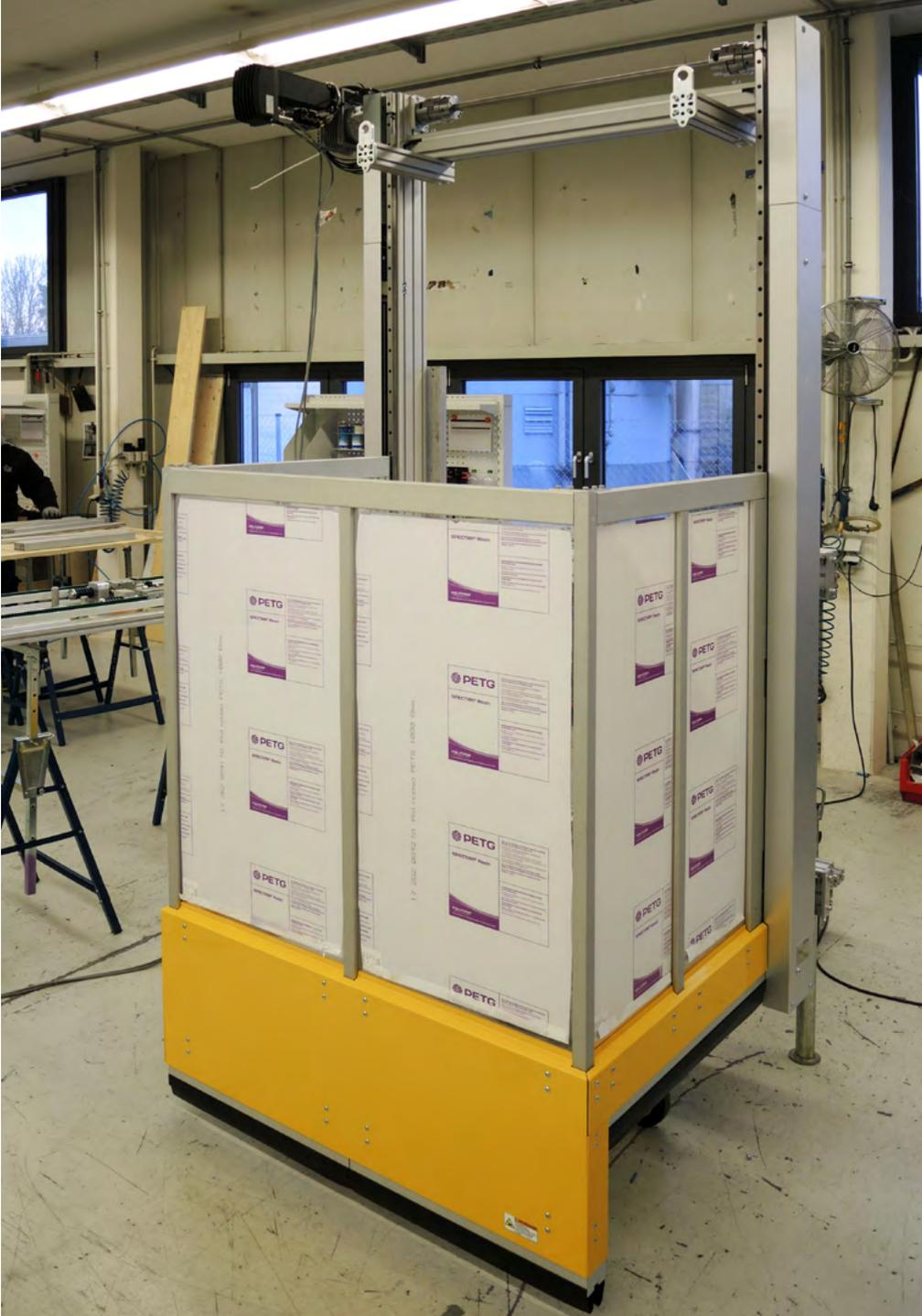
MecLock Vertikal-Schutzfenster SFV.F-B30-E-7200-FO – servoelektrisch angetrieben
