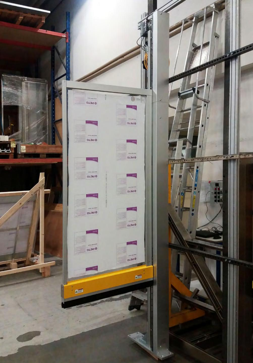
MecLock Vertikal-Schutzfenster SFV.F-B99-E-7200-FO – servoelektrisch angetrieben
