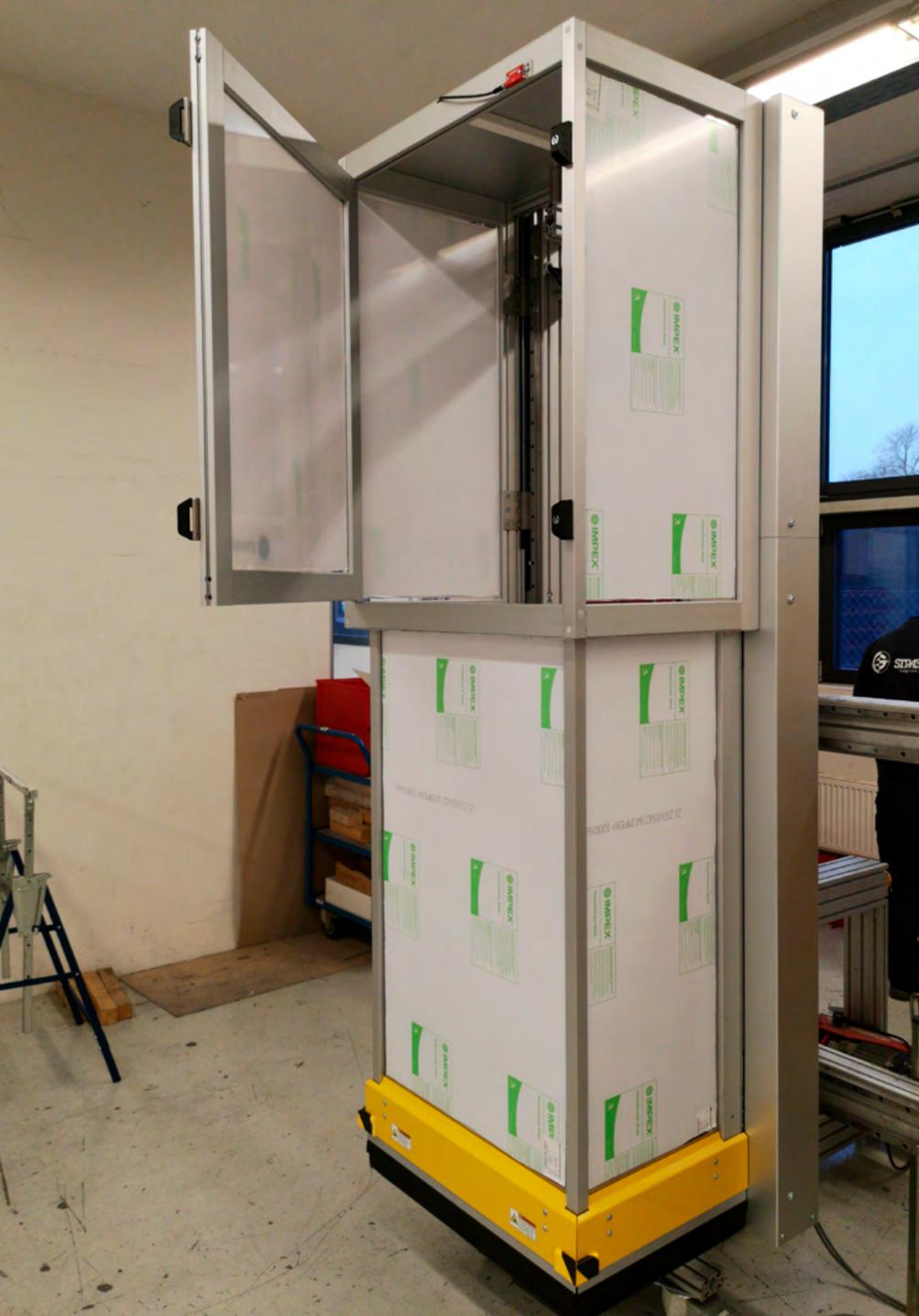
MecLock Vertikal-Schutzfenster SFV.F-B30-E-7200-FO – servoelektrisch angetrieben
