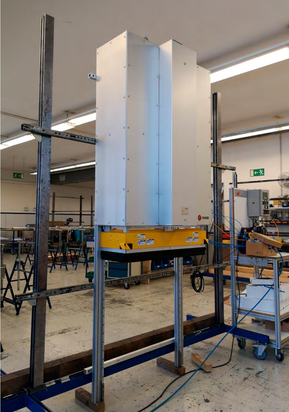
MecLock Vertikal-Schutzfenster SFV.G-B30-P-1175-FO – pneumatisch angetrieben
