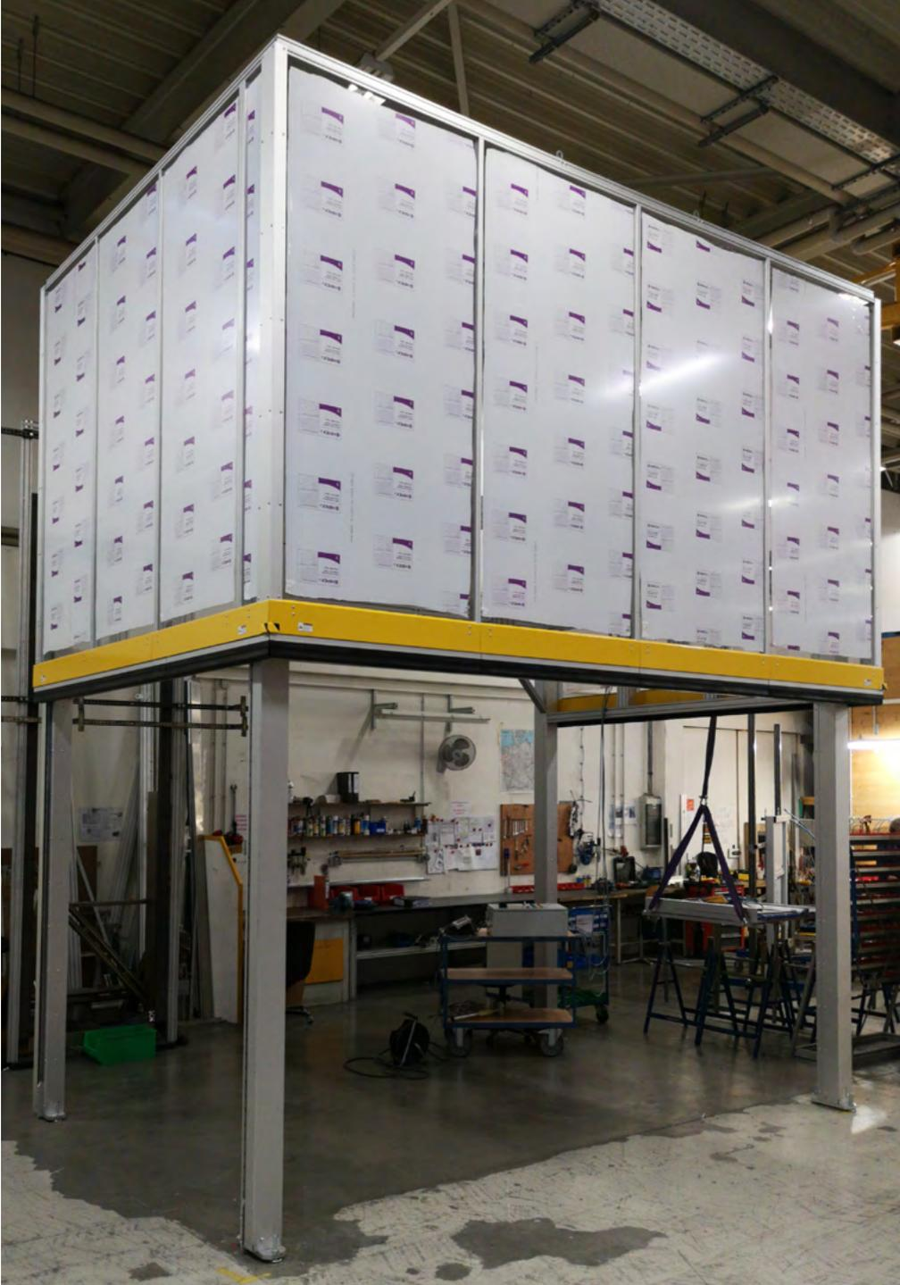
MecLock Vertikal-Schutzfenster SFV.F-B99-E-14400-FO – servoelektrisch angetrieben
