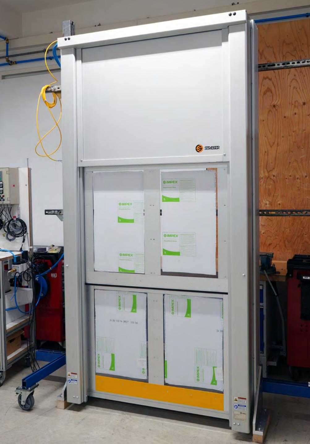
MecLock Vertikal-Schutzfenster SFV.D-B01-P-1500 – pneumatisch angetrieben mit teleskopierendem Scheibenrahmen – Schließrichtung von oben nach unten ohne Querprofil unten – mit hinterfahrbarer Kontaktleiste - geschlossene Endlage
