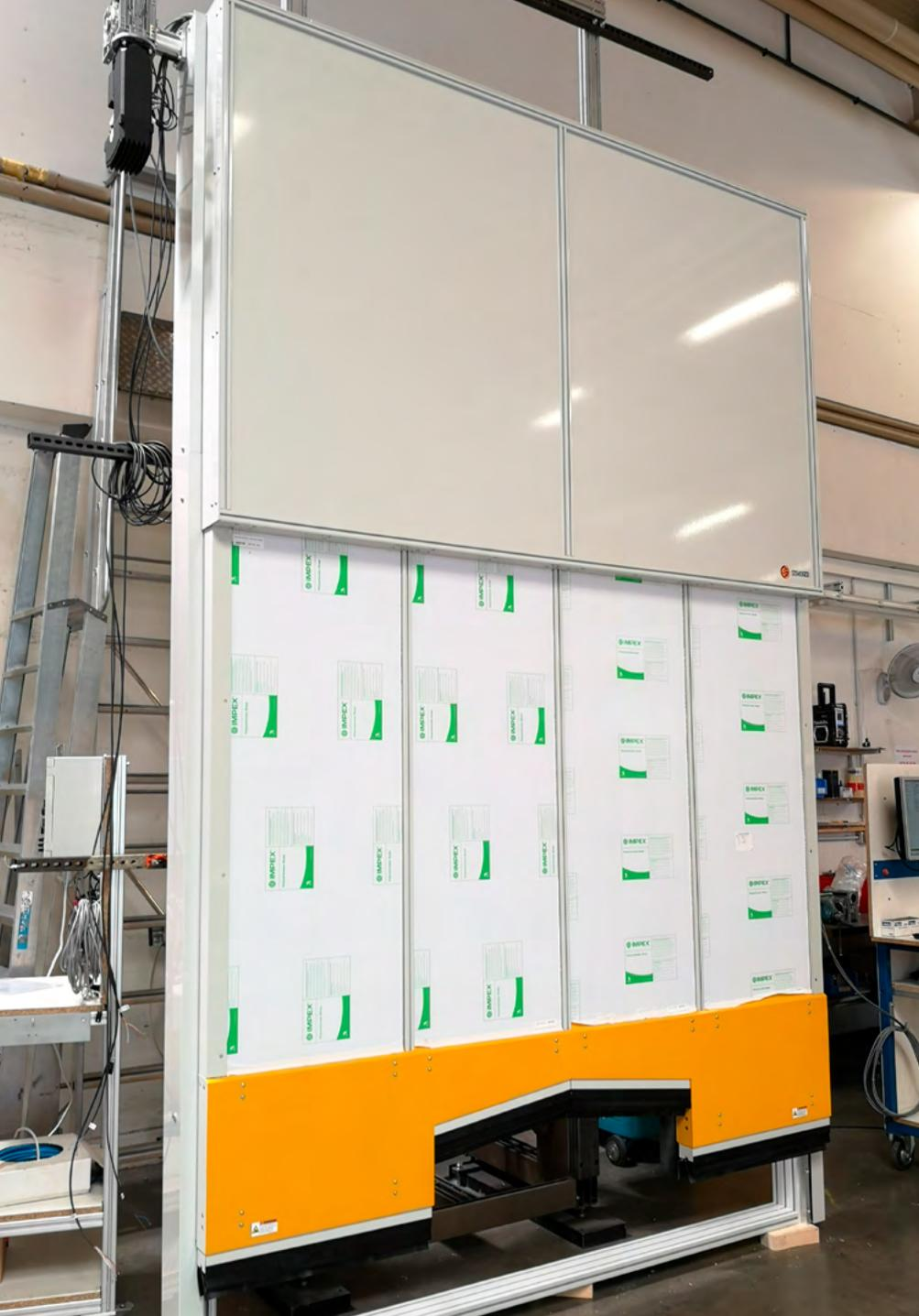
MecLock Vertikal-Schutzfenster SFV.F-B01-E-7200-FO – servoelektrisch angetrieben
