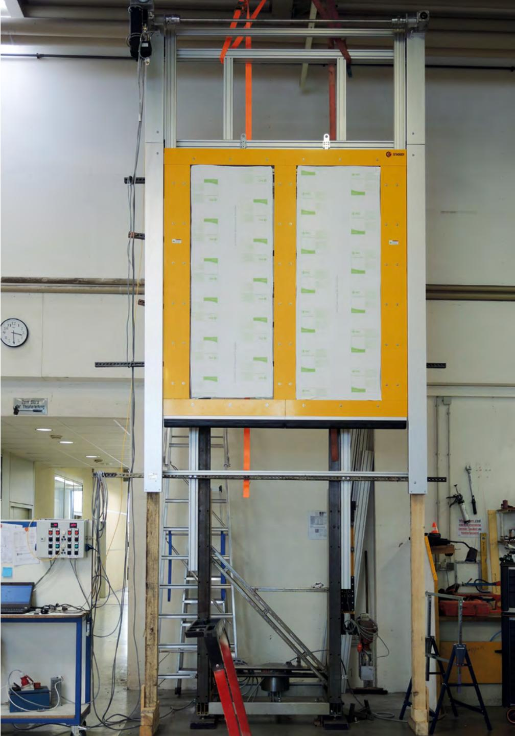
MecLock Vertikal-Schutzfenster SFV.F-B99-E-7200-FO – servoelektrisch angetrieben
