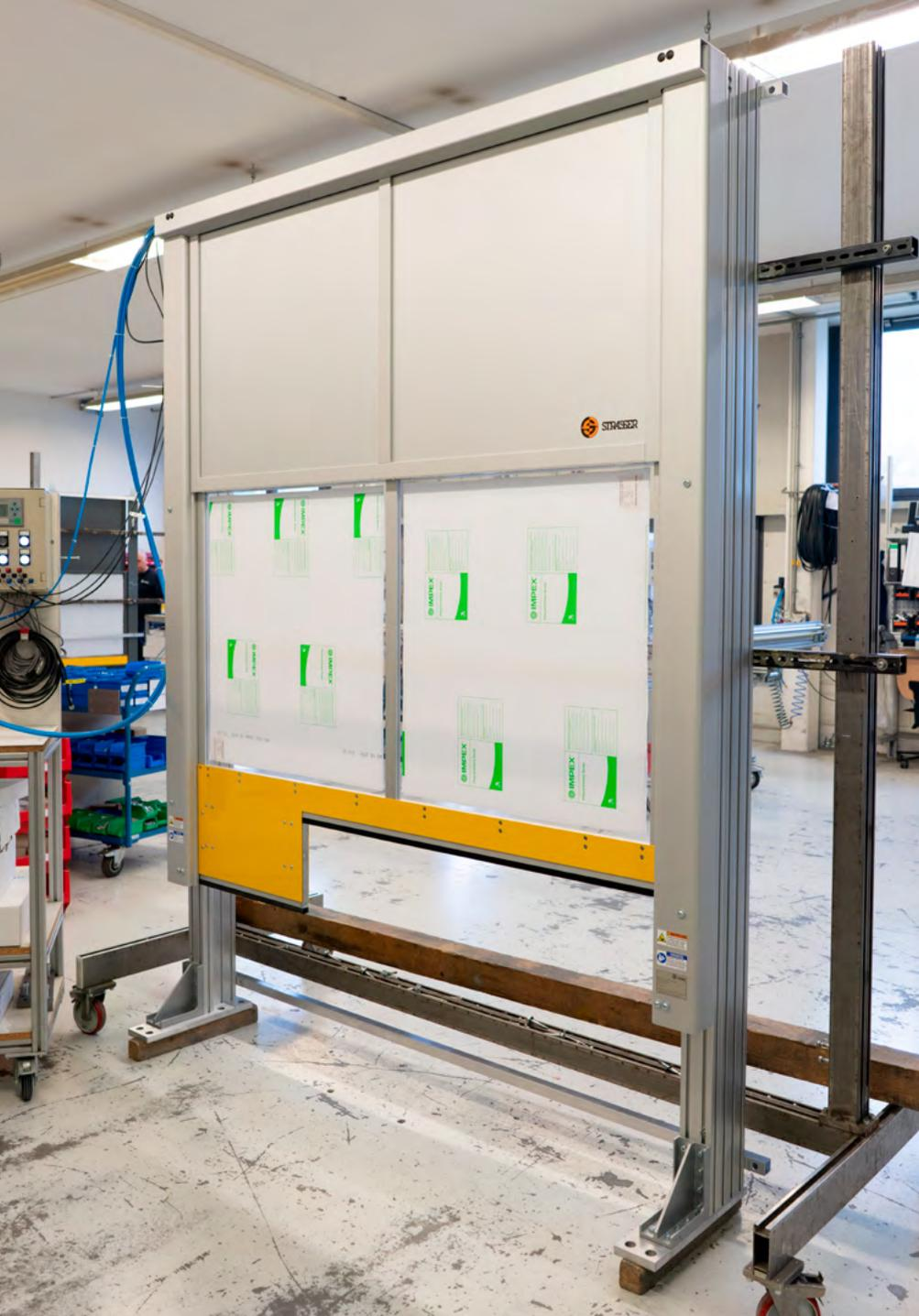
MecLock Vertikal-Schutzfenster SFV.D-B01-P-1500-SO – pneumatisch angetrieben mit konturierter Kontaktleiste für Anpassung Schließkante an Maschinenkontur Ständerausführung
