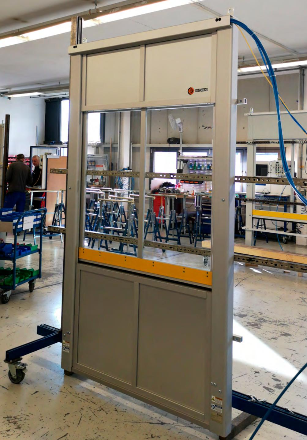
MecLock Vertikal-Schutzfenster SFV.D-B01-P-1500-FMV – pneumatisch angetrieben
