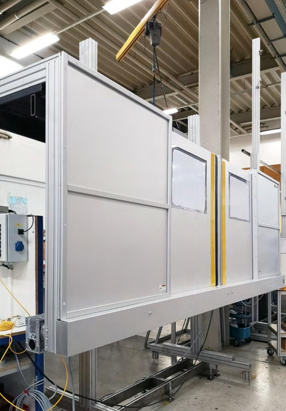
MecLock Horizontal-Schutzfenster SFH.E-B99-E-7200-SA – servoelektrisch angetrieben
