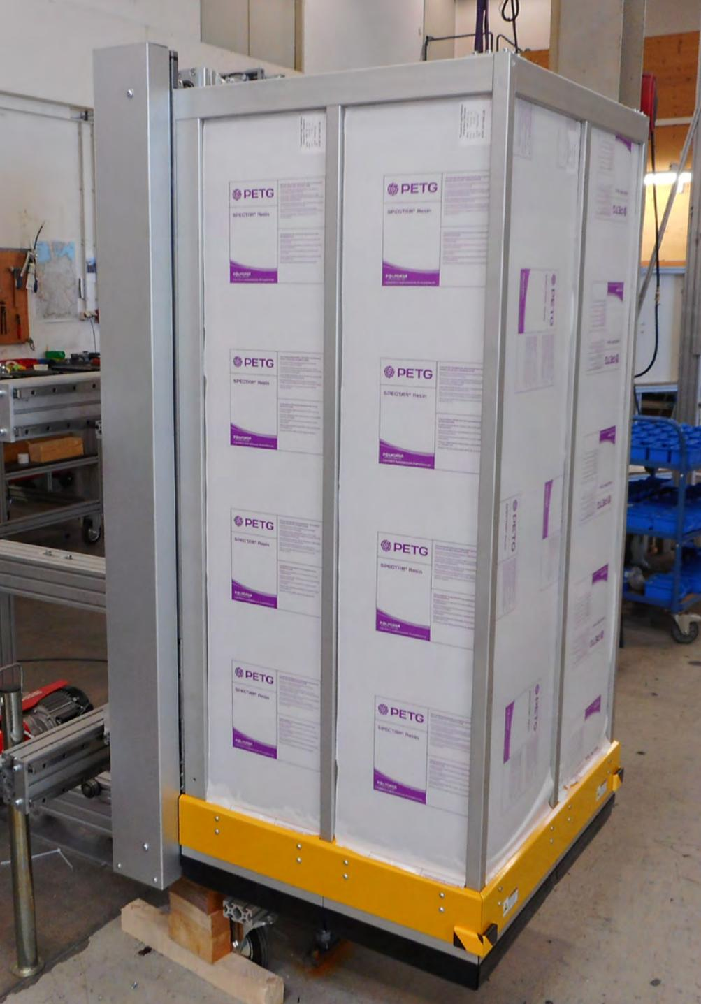
MecLock Vertikal-Schutzfenster SFV.F-B30-E-7200-FO – servoelektrisch angetrieben
