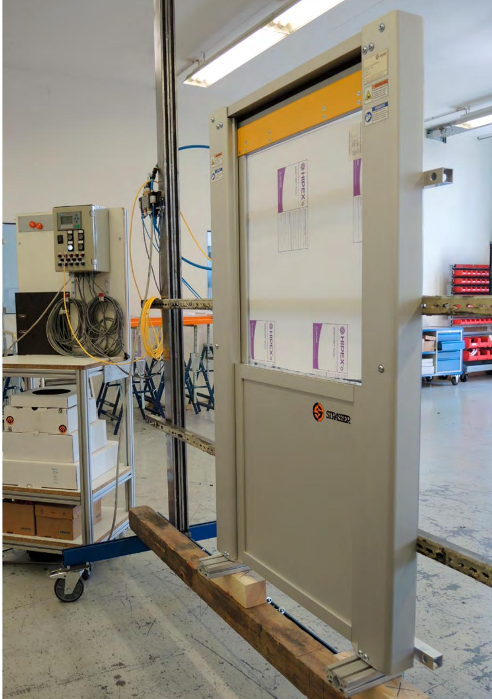
MecLock Vertikal-Schutzfenster SFV.D-B01-P-1500-FM – pneumatisch angetrieben
