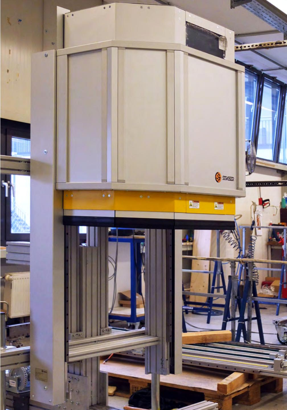
MecLock Vertikal-Schutzfenster SFV.F-B99-E-7200-FO – servoelektrisch angetrieben
